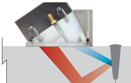
图中显示一个区域的检测情况。采用相控阵技术，同一个探头经过一次扫查可以检测整个区域。在利用相控阵技术检测焊缝时，在焊缝两侧放置的探头可以覆盖焊缝的整个区域。
