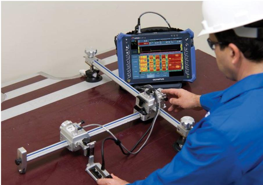
GLIDER XY双轴编码扫查器用于对平面或稍有弯曲的复合材料表面进行手动检测。
