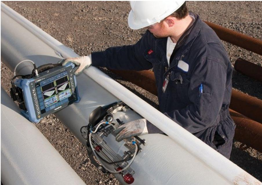
用途广泛的ChainSCANNER双轴编码手动管道检测解决方案可以对外径范围在45毫米到965毫米之内的管道进行检测。这款扫查器通过链接设备而不是磁轮贴附在被测材料上，因此可以检测铁磁性或非铁磁性表面。链接设备有助于确保扫查器沿着直线方向移动，而不会出现偏向问题。此外，在操作人员不能接触到管道上的某些区域时，这个扫查器非常有用，因为操作人员可以拉动其链接设备，使扫查器在管道上转动。
