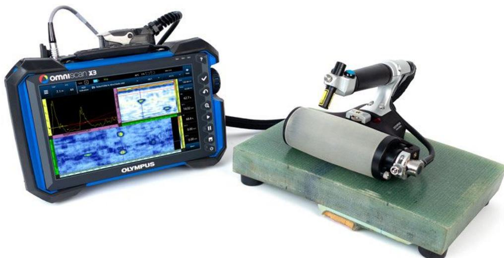
设计符合人体工程学要求的RollerFORM探头，有一个整合型步进点击器按钮。检测人员使用这个按钮可以采集多个单行C扫描，并将这些C扫描实时合并，形成单一图像，从而绘制出被测材料表面的图像。内置激光导向装置方便了笔直、准确的单行扫描。
