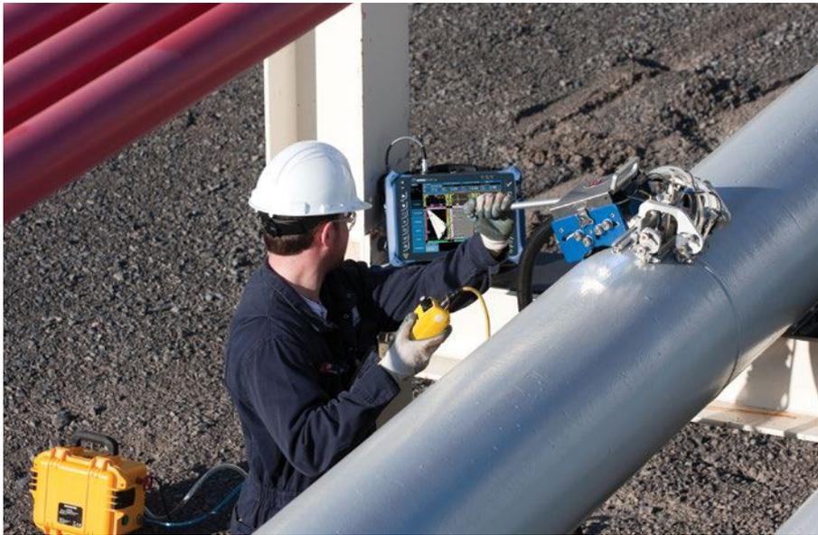
WeldROVER扫查器的设计目的是满足客户在以下方面的需求：需要完成比手动扫查更稳定的检测，但是又希望所用的设备比近海管线建设中常用的高效分区检测系统更经济实用。
