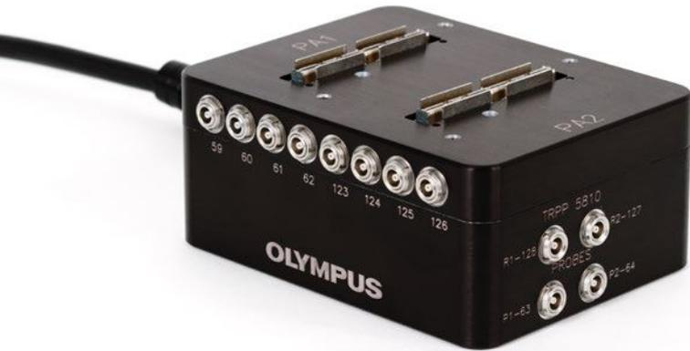
InterBox互连盒是一种符合人体工程学的解决方案，可以解决有关扫查器配件及其连接方面的常见问题。这个紧凑型集线器，除了可以连接由相控阵采集设备启动的8个UT通道以外，还可以连接两个相控阵探头和两个已经放大的TOFD通道。InterBox装置根据不同的配置，可以连接1个PA分流器、1个TRPP 5810 TOFD脉冲发生器/前置放大器，以及最多8个附加的常规UT连接器。
