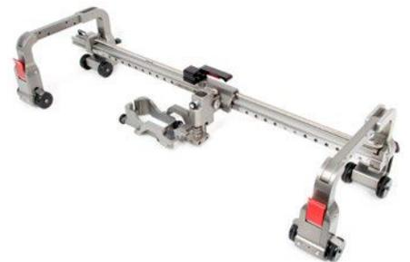
一种MapSCANNER解决方案，用于检测外径从4英寸到平面的铁磁性表面。
