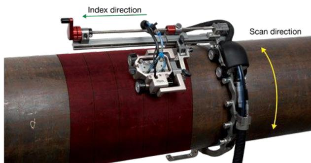
使用HydroFORM扫查器和ChainSCANNER扫查器检测管道时的双轴成像原理。
