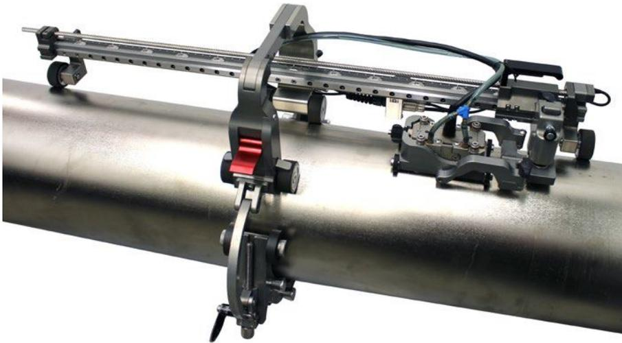
创新型MapSCANNER手动扫查器用于完成腐蚀成像检测。MapSCANNER扫查器装配有一个快速步进系统，并具有扫查宽阔区域的性能，是一款可以高效完成半自动相控阵腐蚀成像检测的理想工具。用户在购买MapSCANNER扫查器时，可以同时购买链接设备；也可以作为ChainSCANNER解决方案的升级设备购买，这种情况下无需购买链接设备，因为您已经拥有的链接设备与MapSCANNER扫查器完全兼容。MapSCANNER扫查器还可以装配磁轮，以检测铁磁性工件，在这种情况下无需链接设备。与HydroFORM扫查器或双晶线性阵列（DLA）腐蚀成像解决方案配套使用时，MapSCANNER扫查器就变为一个可以对剩余壁厚和材料中的异常现象有效完成C扫描成像的性能强大的工具。
