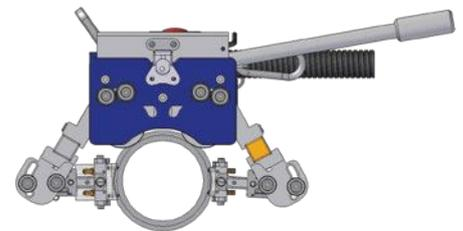
在检测外径为4英寸或更大的管道时，支持位于扫查器后面的两个探头和扫查器前面的两个探头。
