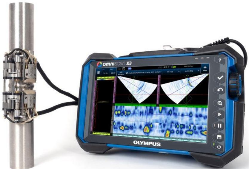
环抱直径为0.84英寸管道的COBRA扫查器，装有两个A15 PA探头，连接了OmniScan MX2 16:64探伤仪，仪器屏幕上以扇形扫描和C扫描形式显示两个PA组。
