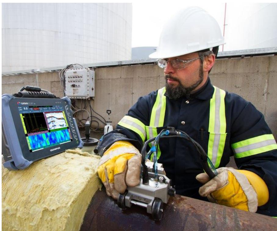
HydroFORM和RexoFORM扫查器的设计目的是为探测由于腐蚀、磨蚀和侵蚀而造成的壁厚减薄情况，而提供一种有效的检测解决方案。这个解决方案还可以探测到壁内的损伤，如：氢致起泡或制造过程中产生的分层，而且还可轻易地将这些异常现象与壁厚减薄情况区别开来。
