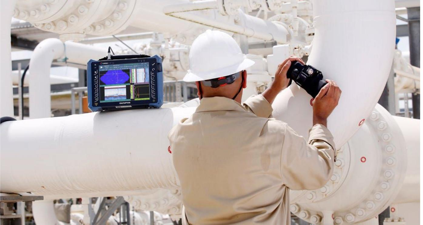
FlexoFORM扫查器可以解决管道弯头检测的难题，而且通过直观的C扫描成像功能，可以显示整个弯头区域的情况。FlexoFORM扫查器解决方案采用了奥林巴斯的柔性相控阵探头技术，可以为外径在4.5英寸以上的管道弯头的腐蚀情况进行成像操作。FlexoFORM扫查器有一个水层，水层贴有泡沫垫圈，垫圈可以贴附在管道弯头的内侧凹面（拱腹）和外侧凸面（拱背）上，以获得优化的耦合效果和可靠的信号。柔性阵列探头的形状由楔块确定，且与弯头的表面呈同心状态，在检测过程中，只需简单地使用0度聚焦法则即可，这一点与对平面的检测相似。水楔是唯一一个需要根据被测管道的不同直径而更换的部件，可以在几秒钟之内对水楔进行更换。扫查器和柔性探头的设计目的是对一定直径范围内的所有管道和弯头进行检测，从而使FlexoFORM扫查器成为一款用途广泛、性价比很高的解决方案。
