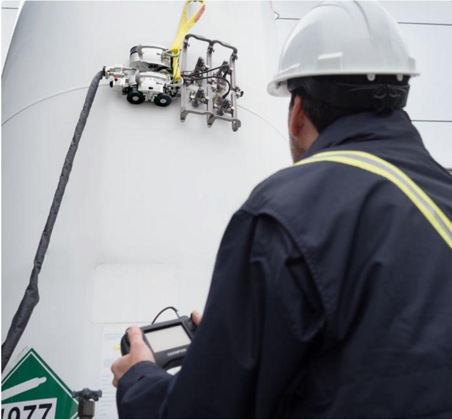
SteerROVER便携式电动扫查器基于已经过野外验证的MapROVER扫查器而开发，而且具有更强的导向性能，操作人员可以远程方式自如地控制这款扫查器。操作人员在检测难以接触到的大面积铁磁性区域时，如：压力容器和箱罐，扫查器的这种操控自如的性能非常有用。扫查器经过配置后，借助一种电动光栅臂可以完成腐蚀成像操作，还可以借助一种支撑探头托架的支架，对（纵向和环向）焊缝进行检测。可以通过一种直观的触摸屏远程控制装置对扫查器进行控制，因此无需将笔记本电脑带到检测现场。唯一的连接是电源控制器和OmniScan或FOCUS PX探伤仪的编码器输入之间的连接。
