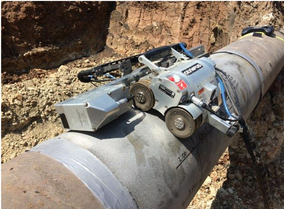
MapROVER扫查器使用两个电动轴进行扫查，因此提高了检测效率。使用触摸屏远程控制装置，可以非常方便地控制扫查器，因此不需要计算机或编制复杂的电机控制器程序。当MapROVER扫查器与HydroFORM相控阵腐蚀成像解决方案组合在一起使用时，就成为一种可对剩余壁厚和材料内的异常现象进行C扫描成像操作的非常强大的工具。在使用OmniScan SX UT探伤仪进行常规双晶UT检测时，MapROVER扫查器与更为复杂的系统相比，则是一款简单实用且性价比很高的选择。
