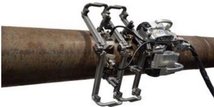
在对纵向焊缝进行检测时，可以使SteerROVER扫查器和支撑探头托架的支架呈弯折状态。
