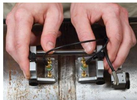
HST-X04 TOFD手动扫查器为用户提供了一种高效、经济的焊缝检测解决方案。
