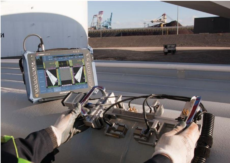
HSMT-Compact手动单轴编码扫查器的设计目的是在维护管道时，对焊缝进行检测。这款扫查器小巧、轻便、用途广泛，可最多使用4个探头对平面材料及外径最小为114.3毫米的管道进行环向扫查。可以对扫查器的宽度进行调整，还可以使扫查器的框架延伸到磁轮以外的区域，以为用户提供一种适用于检测难以接触到区域的配置，如：直管与管件的焊接部位。
