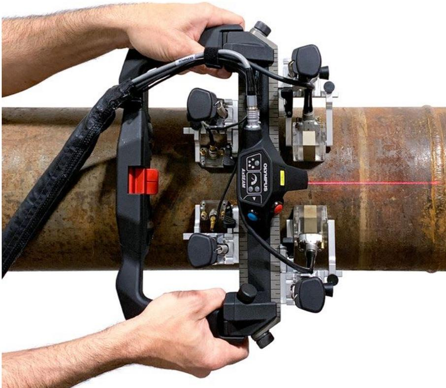
检测管道的纵向焊缝比检测周向焊缝更具挑战性。AxSEAM扫查器的用户只需稍微进行简单的调整，就可以在纵向扫查和周向扫查之间轻松变换，改变探头间距，或者根据管径的变化调整扫查器的配置。
