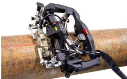
AxSEAM扫查器可以扫查外壁直径从152.4毫米到平面的管道上的纵向焊缝。
