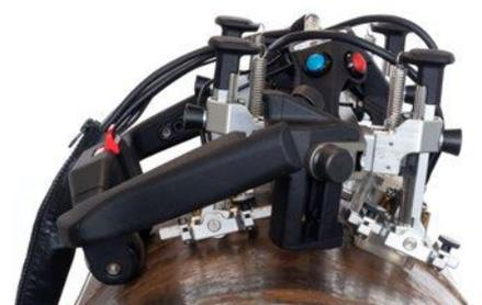
AxSEAM扫查器装配4个探头时，可以在外壁直径等于或大于254毫米的管道周向上进行扫查。
