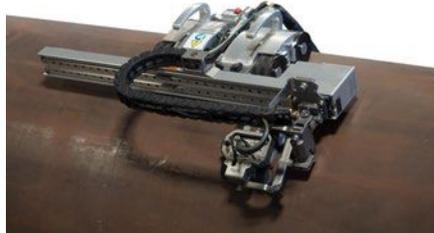
SteerROVER扫查器在装配了电动光栅臂时，就变成一种可以远程方式检测腐蚀区域的性能强大的解决方案。
