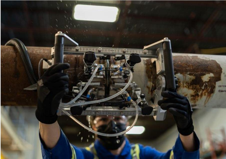
HSMT-Flex扫查器是奥林巴斯迄今为止对环焊缝进行单轴编码检测的能力最强的半自动扫查器。扫查器的标准配置包含4个下一代探头托架，如果购买了4个可选的额外探头托架，可以总共安装8个探头。为了提供优化的效率和探测能力，安装的探头可以是相控阵（PA）探头，传统UT探头，也可以混合安装不同技术的探头。由于经过简化的探头托架设计带有无需工具即可操控的机制和垂直锁定系统，在更换和调整探头和楔块时可以节省很多时间。
