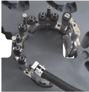
图 2-15 安装母链部件和 / 或中链部件
