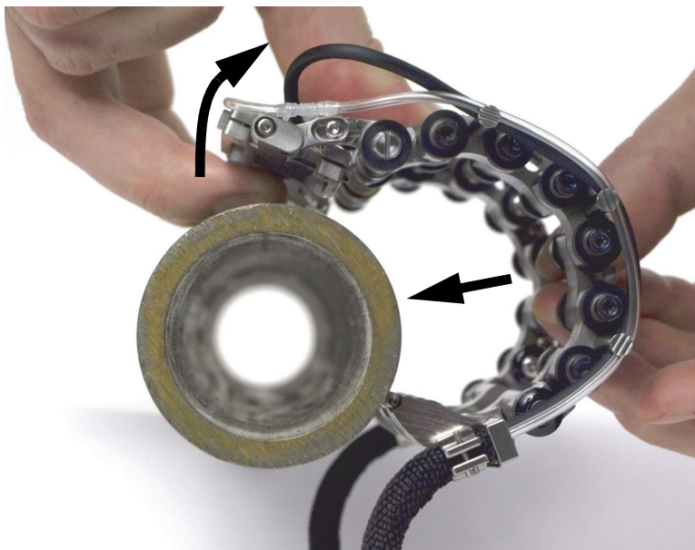
图 2-28 将扫查器安装到直管上
