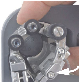
图 2-17 旋转探头架，为外径小于 33.4 毫米的直管定位
