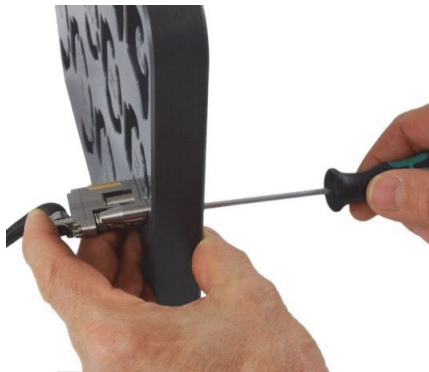
图 2-9 紧固尾部组件的调节螺钉
