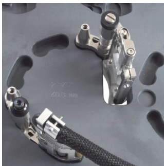
图 2-13 将探头架安装到设置模板中
