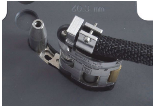
图 2-8 将尾部组件嵌入设置模板的槽中
