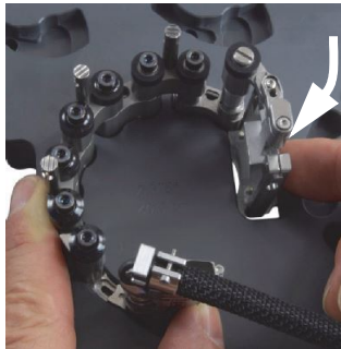
图 2-16 旋转探头架，为外径大于 33.4 毫米的直管定位
