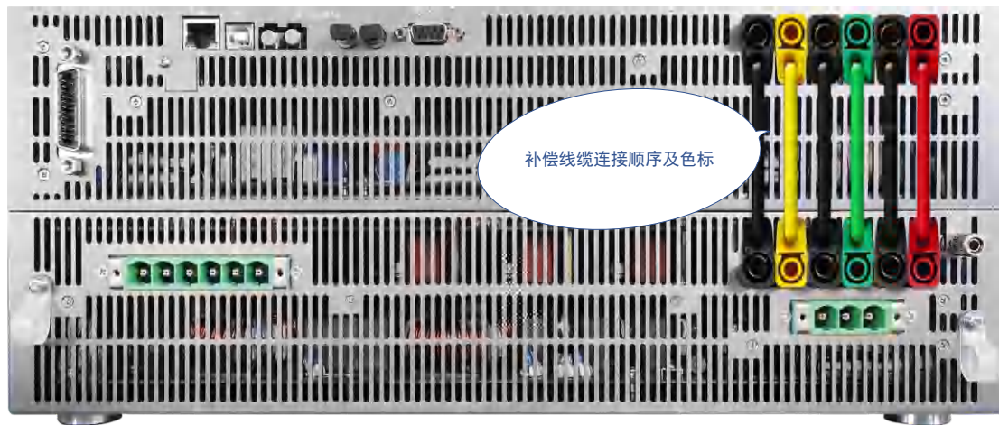
图 93 补偿线缆连接顺序及色标
