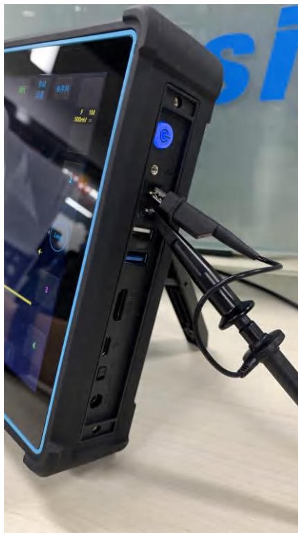
图2-13 探头连接方式
