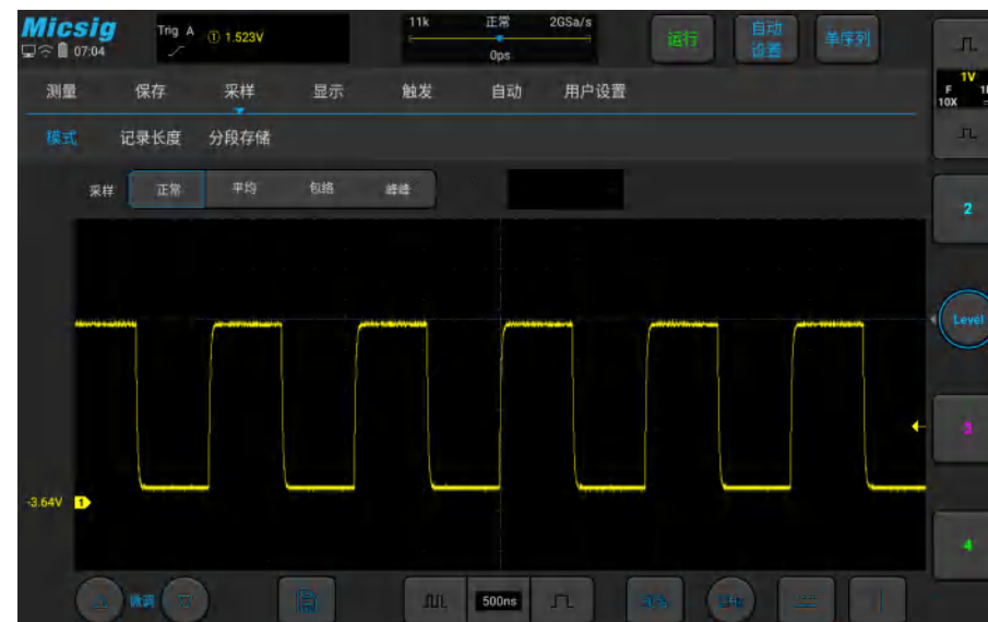
图10-6 带毛刺的波形，正常采样模式
