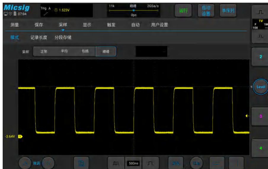
图10-5 带毛刺的波形，峰值采样模式
