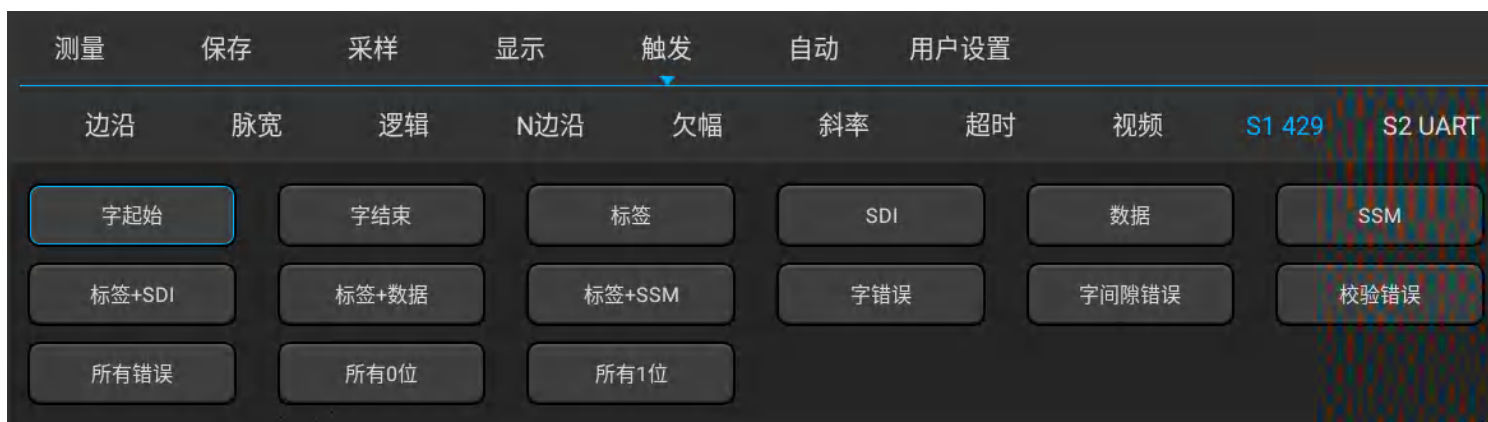
图11-27 ARINC429 触发方式配置菜单
