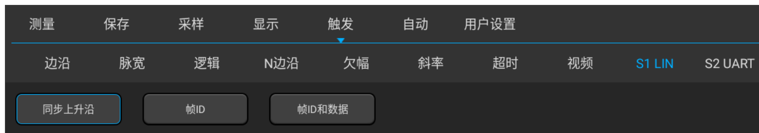
图11-11 LIN 触发方式配置菜单
