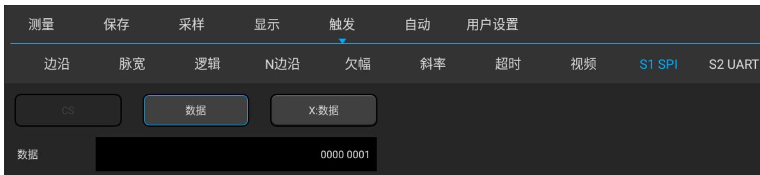
图11-19 SPI 触发方式配置菜单
