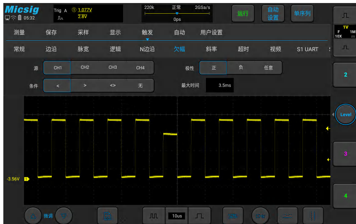
图5-25 欠幅触发设置菜单
