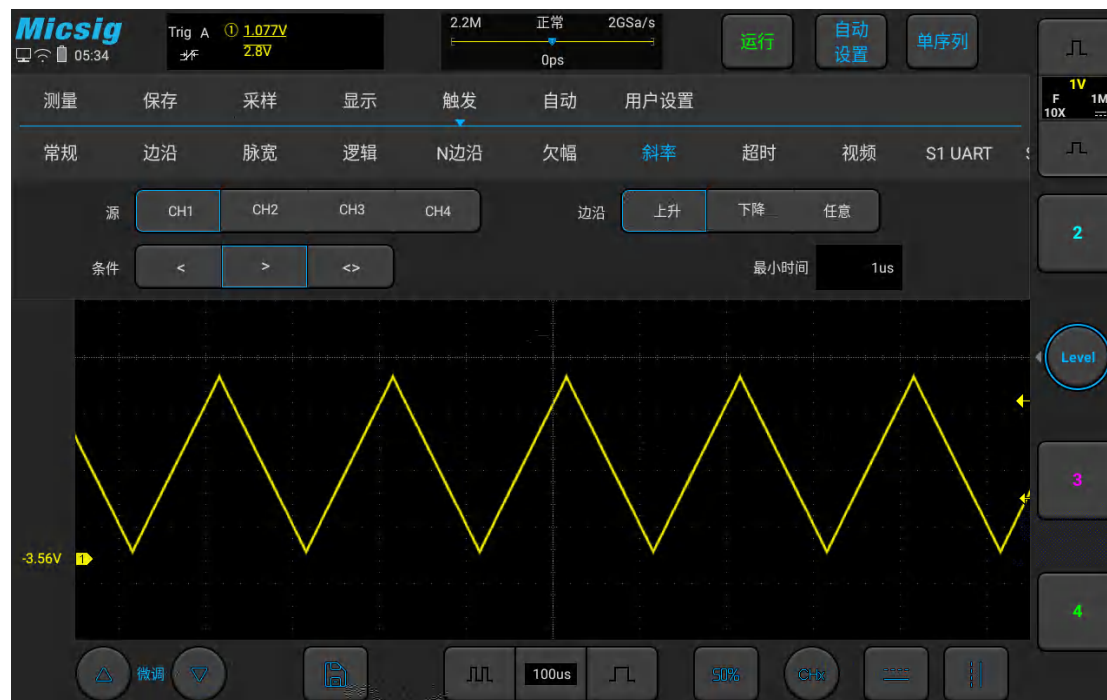
图5-27 斜率触发设置菜单
