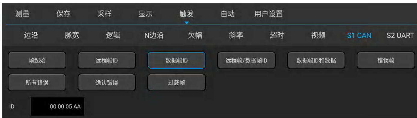
图11-15 CAN 触发方式配置菜单
