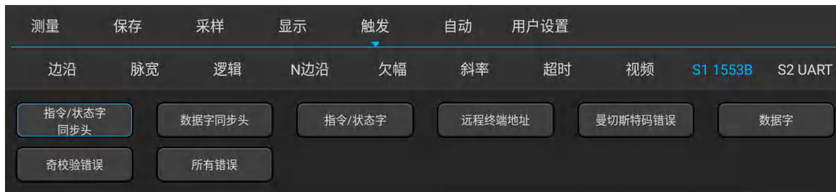
图11-31 1553B 触发方式配置菜单
