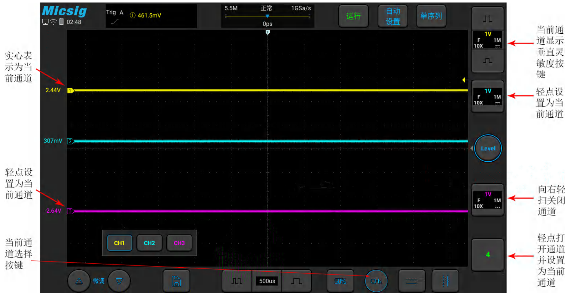
图4-4 通道的打开、关闭与切换
