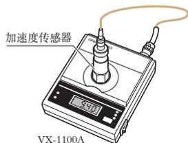
〔使用示例②〕只使用激振器，进行振动测量系统的校准。
