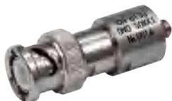
本仪器是简易电荷放大器，用于将电荷信号转换成电压信号。将本电荷转换器用于振动比较仪（VC-2200/3100）或FFT分析仪（CF系列，DS系列），无需再单独安装其他的电荷放大器，可直接将电荷输出型传感器连接到测量仪器（CCLD支持机型）上使用。
