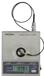
压电型加速度传感器在振动测量方面被广泛应用。为了得到正确的测量数据，在使用前必需对传感器的动作(灵敏度)进行确认。
