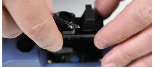
功率计和VFL选件易于安装在MAX-FIP的显示屏上面，只需使用四个螺丝。
