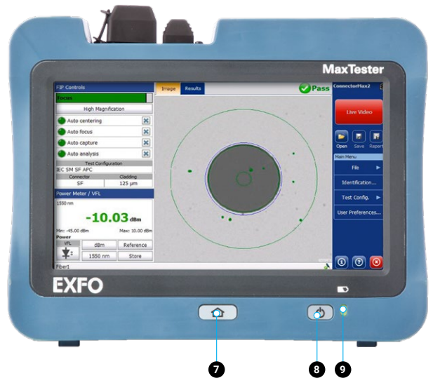
功率计和VFL选件易于安装在MAX-FIP的显示屏上面，只需使用四个螺丝。
