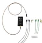
专为探测低阻抗功率/电压轨测试设计，RP4030具有30V内置偏移调整能力，低衰减(噪声)和高直流输入阻抗、4GHz的带宽，包括焊接和U.FL插座连接在内的各种各样的可替换前端
