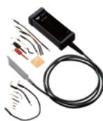
ZS系列有源单端探头具有较高的R值(1 MΩ)和较低的C值(0.9pF)，从而减少整个探头/示波器带宽上的电路负载效应。ZS1000适合于带宽200–600MHz的示波器，ZS1500适合于1GHz带宽示波器，ZS2500适合于2GHz带宽示波器。更低的电路负载效应，加上特别设计的探头附件，使ZS系列有源探头可以用于高频测试和测试点更狭小的空间，如芯片引脚测试等。
