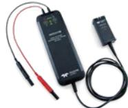
HVD系列高压差分探头允许功率电子电路进行浮地测量，而示波器可以安全接地。高频时其优秀的共模抑制比(CMRR)且具有低噪声，高偏移电压调节及高DC增益精度的特点使其成为单相和三相功率电子设计中高压和浮地控制信号测量的理想选择。
