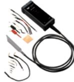
高输入阻抗 (1MΩ)、低至0.9 pF输入电容以及大量探头前端和接地附件，使这些低成本单端探头成为很多应用的理想选择，ZS系列可提供高达4 GHz的带宽。
