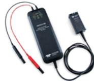
可提供1,2或6 kV共模电压输入范围，高频时优异的CMRR (65 dB @ 1 MHz) 与低固有噪声、宽差分电压范围、高偏置电压能力和1%的增益精度相结合，是功率转换系统测试的理想探头。
