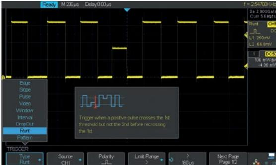
具有丰富的触发功能,包括边沿、斜率、脉宽、视频、窗口、欠幅、间隔、超时、码型、IIC、-SPI、UART/RS232、LIN、CAN
