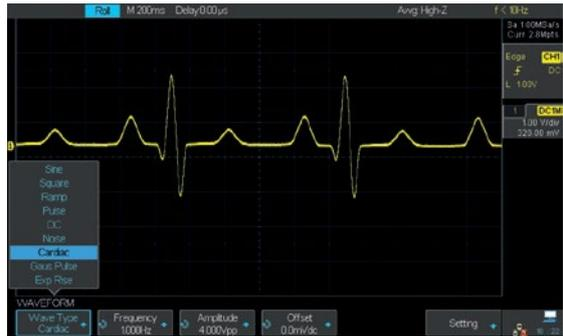
内置了25MHz 函数/ 任意波形发生器，集成了10 种常用波形，用户也可通过EasyWave 上位机软件编辑任意波形
