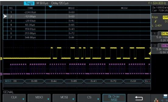
通过事件列表显示解码，能快速、直观地将总线的协议信息以表格形式显示
