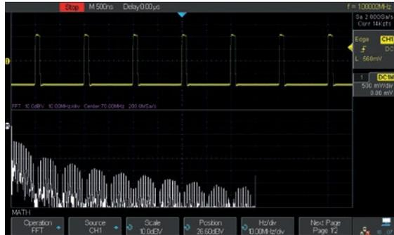
除传统的 (+, -, \*, /) 运算外，还支持FFT、微分、积分和平方根运算。积分运算支持gating积分，用光标设定积分的时间段
