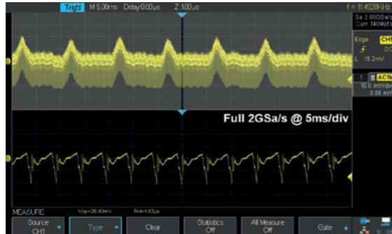
最大140Mpts 的深存储,用户能够使用更高的采样率捕获更长时间的信号,然后快速放大需要关注的区域,做到整体与细节的兼顾
