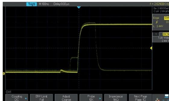
高达500,000 帧/秒的波形捕获率 (Sequence 模式),使示波器能轻松捕获到异常事件或低概率事件
