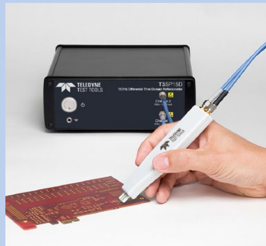
基于真正差分设计，测量差分通道时，无需物理接地连接
