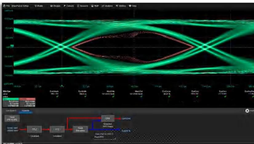
WavePulser 40IX模拟完整串行数据通道的眼图
