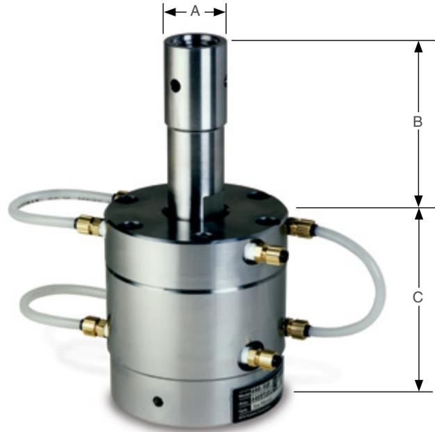
MTS 系统公司还可以提供超过1000° C (1832° F)的非标准型680系列高温低周疲劳测试夹具，包括与之对应的高温引伸计和高温炉等全套解决方案，请联系MTS系统公司的应用工程师予以确认细节。
