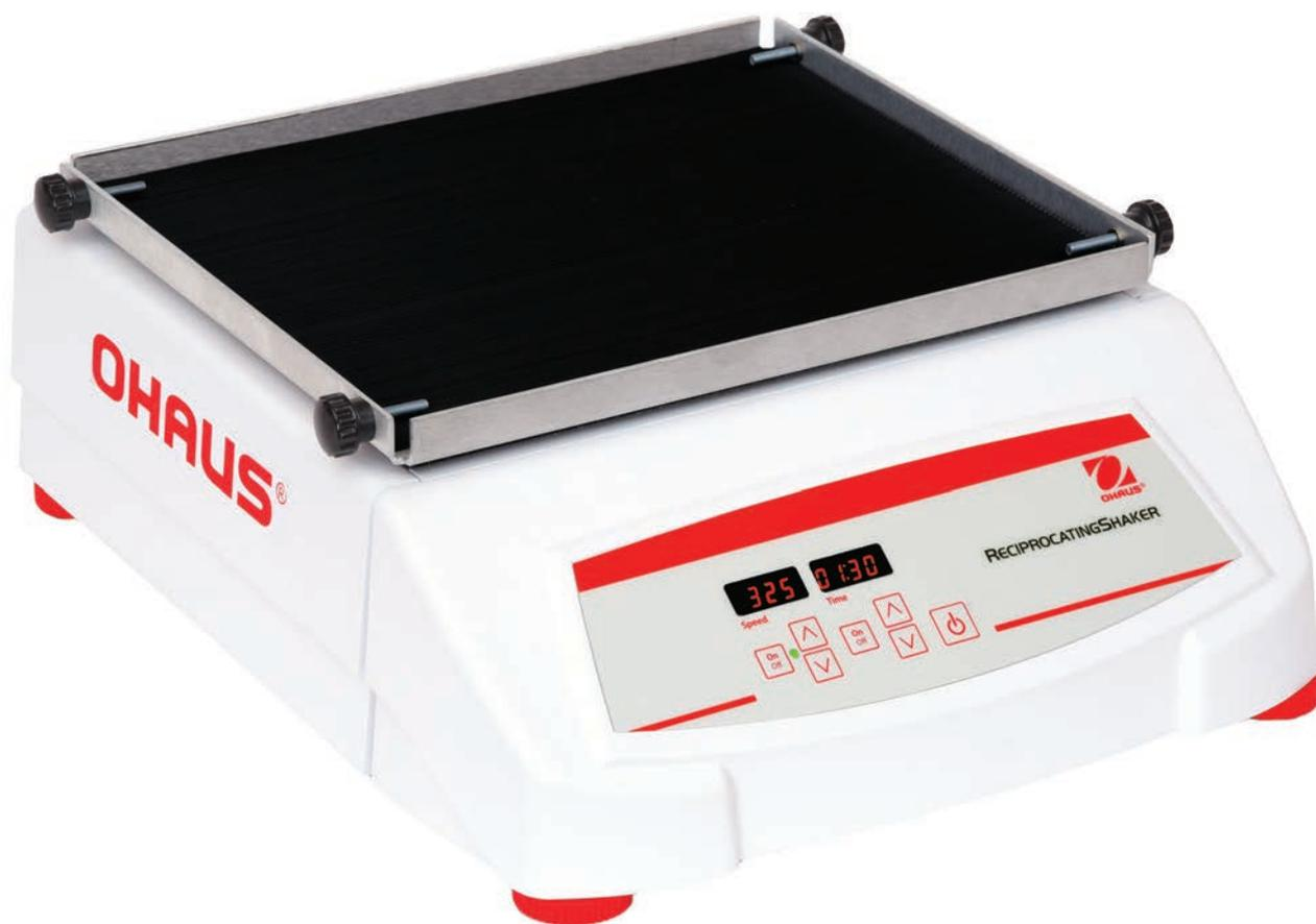
奥豪斯往复式摇床适用于要求结果准确和可重复的各种应用，包括细胞培养和提取等。摇床配备微处理器控制器，可提供一致均匀的摇荡动作。前后往复动作的行程长度19mm。永久润滑滚珠轴承以及无需维护的无刷直流电机确保可靠运行和连续工作。
