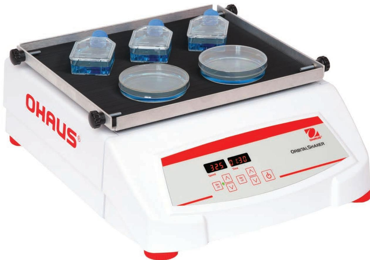
奥豪斯大负载圆周式摇床载重量大（16 kg-68 kg），超70个选件供客户选择，应用广泛。模拟控制和数显控制两类产品均配置微处理控制器，在摇荡过程中不仅方便用户变速、确保升速至设定速度时样品的安全，而且摇荡动作始终一致、均匀。微处理控制器将显示最后一个设置值，可在断电后重新启动。所有产品均含内置托盘和防滑橡胶垫。
