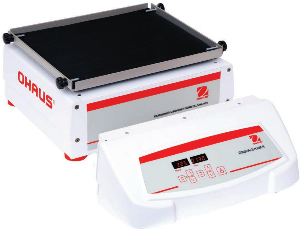
适用于细胞培养对二氧化碳和湿度有特殊要求的应用，奥豪斯极端环境摇床可用于严苛的环境，如二氧化碳培养箱等。分体式控制器（通过磁铁固定在大多数培养箱的外侧）可实现外部控制，摇床基座放在培养箱内部。微处理控制器确保摇荡一致性的同时兼顾升速的安全。
