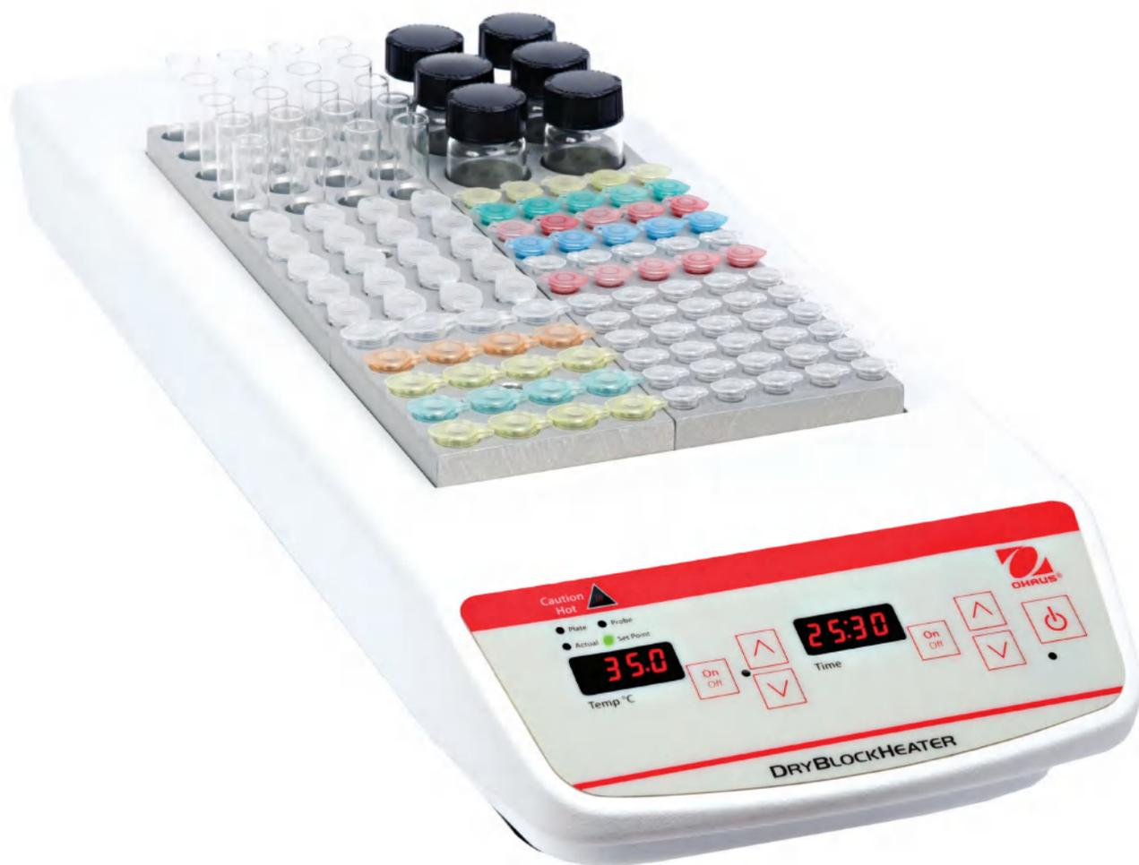
多用途干式金属浴适用于对温度稳定性有严格要求的应用。试管与模块壁紧密接触可实现最大的热量保留，并实现高效加热。高功率、固定温度的模拟控制型号是一种经济型选择，而数显控制型号则提供了卓越的温度一致性和稳定性，适合需要可重复结果的试验。设备可适配40多个可换恒温模块。
