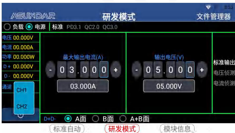
电压侦测：选择“电压侦测”，可侦测被测负载所支持的电压范围。
