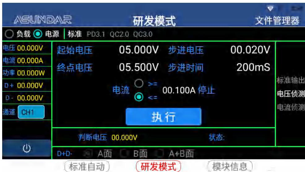
电流侦测：选择“电流侦测”，可侦测被测负载所支持的电流范围。
