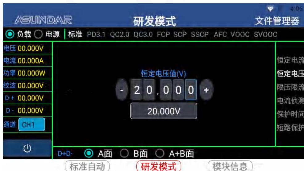
**限压限流**: 选择“限压限流”，其负载电流不超过限流值，负载电压不低于限压值。当限流参数较小，限压参数较大时，类似于恒流负载。当限流参数较大，限压参数较小时，类似于恒压负载。
