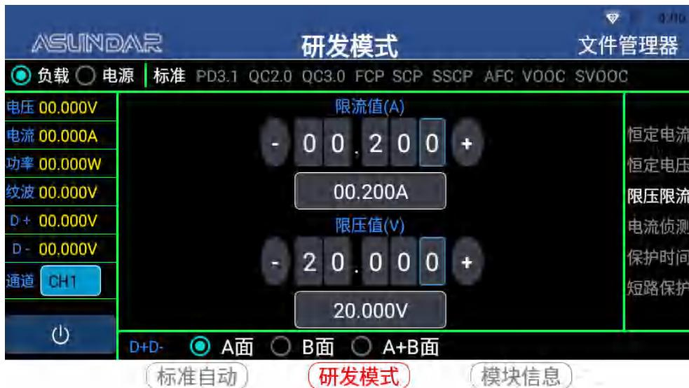
**电流侦测**: 选择“电流侦测”，可测试产品的过流保护电流值。
