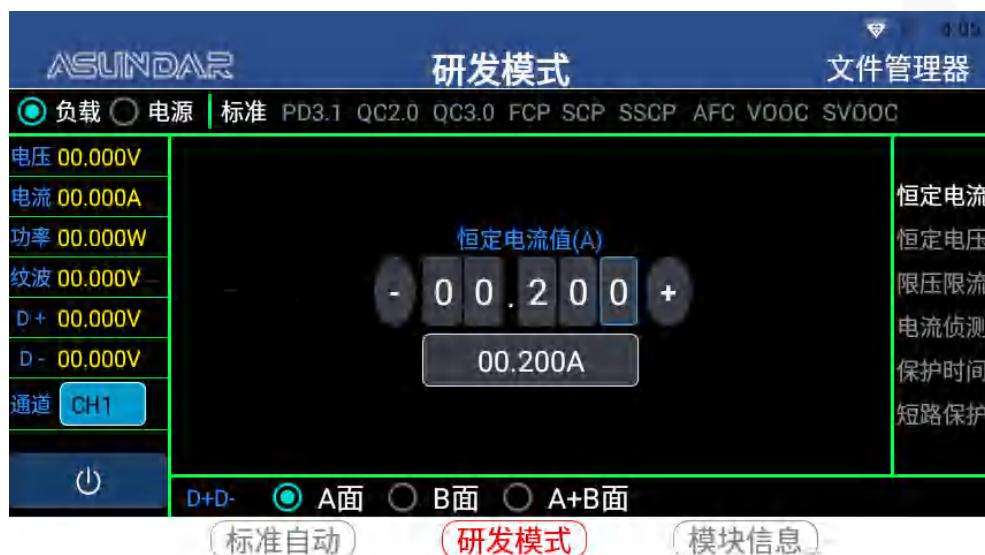
**恒定电压**：选择“恒定电压”，即负载的“恒压（CV）”方式，可设定负载电压。根据产品输出电压和负载所设定恒压电压的差值及传输内阻决定负载电流及功率。
