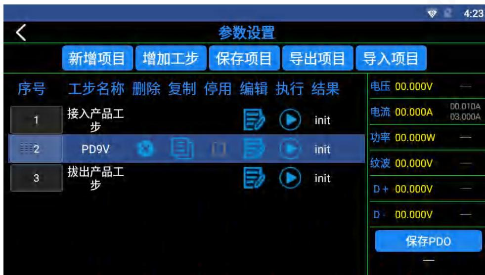
每项工步均可做删除、复制、停用、编辑操作，长按名称可编辑名称，长按序号可上下拖动调整顺序，点击执行图标可执行单项测试。点击“编辑”图标可进入参数设置子菜单。
