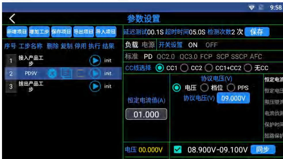
点击“新增项目”输入项目名称，点击“增加工步”进行参数编辑，并保存工步。根据需要设置多项测试工步，每项工步均可选择负载或电源状态，设置协议类型，电压电流等参数，并可指定测试通道。完成工步设置后，点击“保存项目”可返回主界面执行测试。测试项目可导出至USB存储设备，或由USB存储设备导入到参数设置界面。
