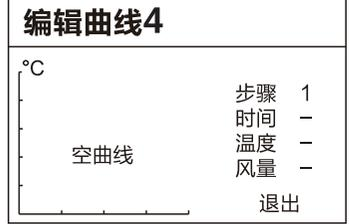
步骤：热风手柄工作时运行的步骤（最多9个步骤）。
