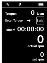
无线控制器打开数秒后, 出现开机屏幕, 屏幕显示仪器名称、软件版本。之后, 此工作界面出现。
