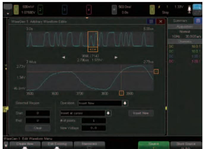
图28. 任意波发生器的信号编辑界面。
