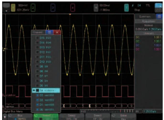
图 46. FPGA 动态探头屏幕截图
