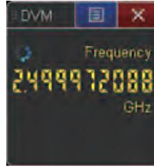
图 32. 10 位计数器精确测量 2.5 GHz 信号的频率
