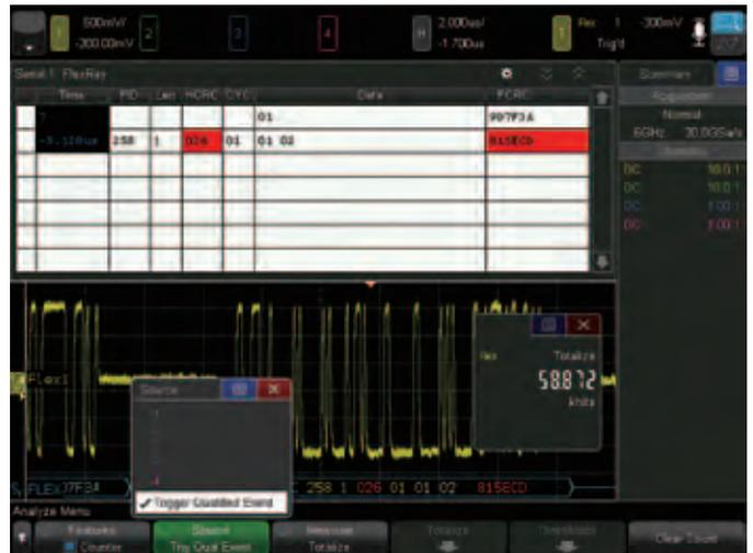
图 34. 计数 CAN 误码包的总数
