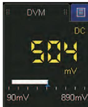
图 31. 电压表显示，完全和示波器通道独立
