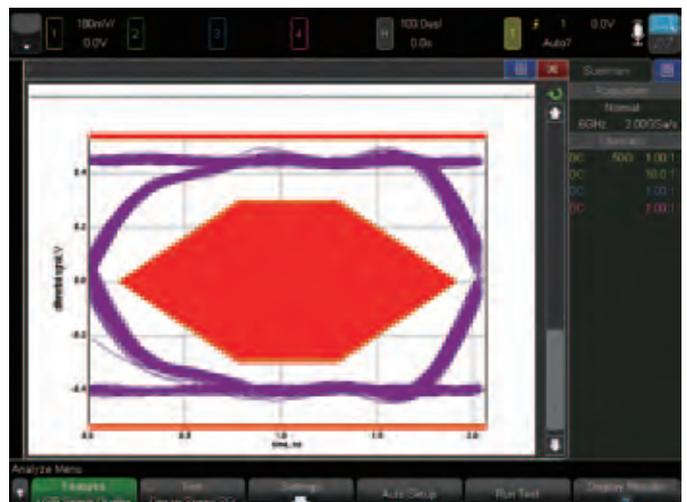
图 44. USB 2.0 高速近端眼图测试
