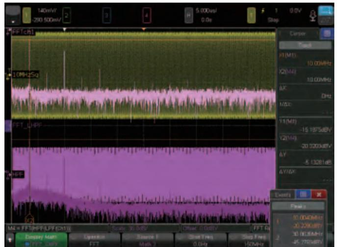
图48. 同时使用4个数学函数(其中三个函数已启用)
