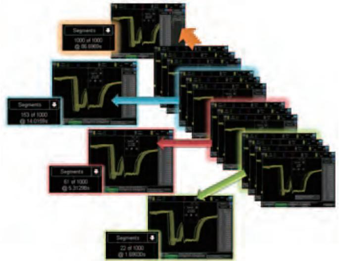
图 22. 分段存储器的图形显示。
