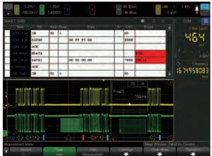
图 30. USB 2.0 协议触发与解码选项的结果显示。
