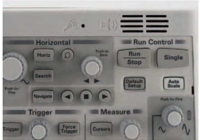
图 39. 用于语音控制的麦克风和扬声器
