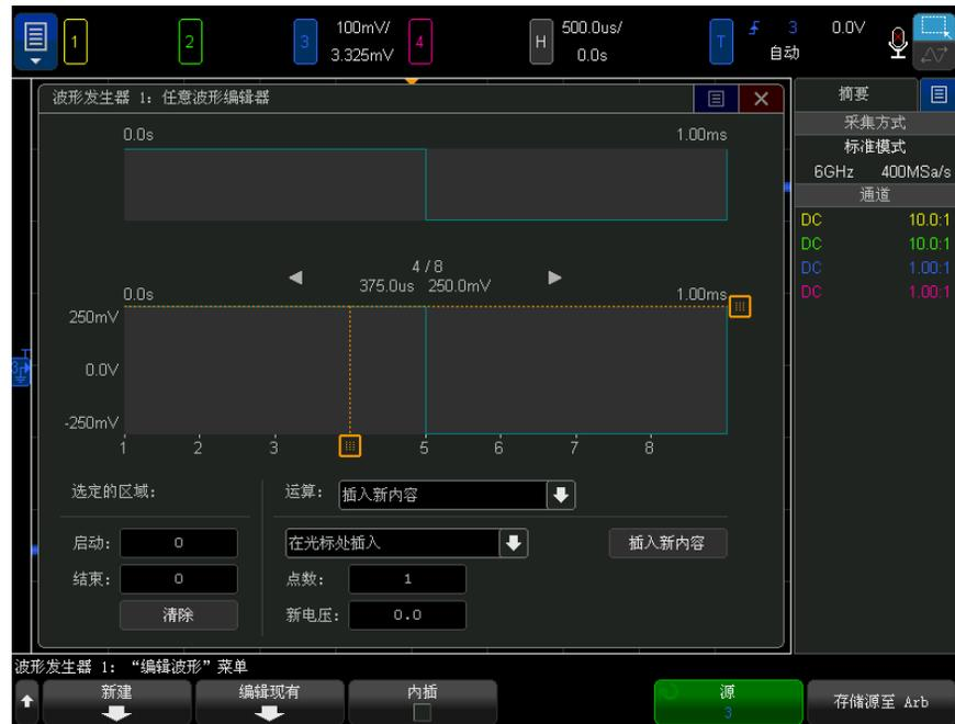
打开“编辑波形菜单”后，可以看到现有的任意波形定义。在图中看到的电压和时段是边界参数 — 它们来自“波形发生器”主菜单中的频率和幅度设置。
