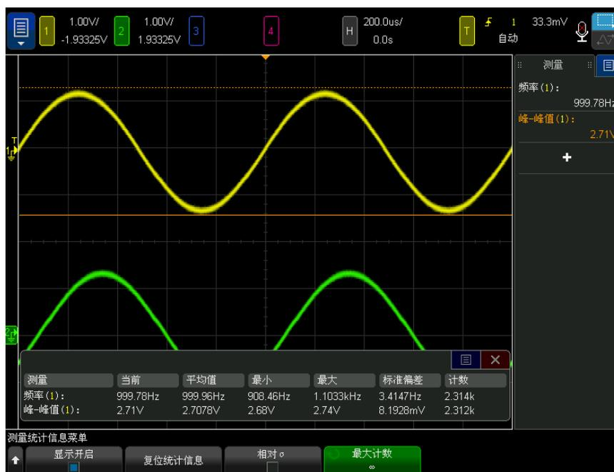
测量的源通道显示在测量名后的括号内。例如：“频率 (1)”表示通道 1 上的频率测量。
