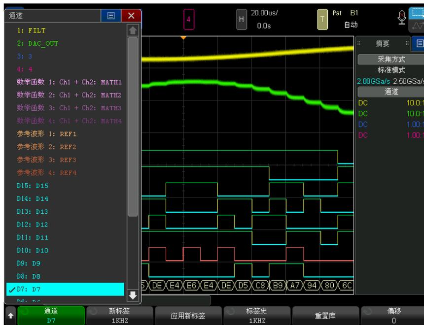
上面的图显示通道的列表和它们的默认标签。将标签分配给通道并不要求打开通道。
