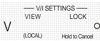
Wenn der Ausgang noch eingeschaltet ist, blinkt **OP on** (Ausgang Ein) zweimal im Display, gefolgt von einer 2-3 Sekunden währenden Blinkanzeige der neuen „unverriegelten“ Einstellungen (erst langsam, dann schneller), bevor die Änderung schließlich durchgeführt wird. Die LOCK Lampe erlischt, wenn die Änderung erfolgt ist.
