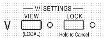
La tensione impostata e il valore massimo di corrente sono sempre visualizzati quando l'uscita è disinserita, ma sono visualizzabili anche quando l'uscita è inserita premendo il tasto VIEW; la spia VIEW si accende mentre si preme il tasto VIEW.
