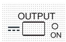
All'accensione, il valore predefinito dal fabbricante è uscita disinserita. La tensione e la corrente impostate per l'uscita dipendono dai valori attualmente impostati, visualizzati sul display. La spia VIEW si accende per indicare che i valori visualizzati sono quelli predefiniti. Tutti gli altri valori. Tutti gli altri valori sono quelli impostati in occasione dell'ultimo disinserimento.
