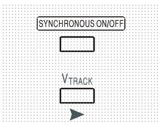
La pressione del tasto  $V_{TRACK}$  seleziona la modalità monitoraggio tensione. Le due uscite rimangono elettricamente isolate, ma i controlli Voltage dell'uscita 1 (Master) impostano la stessa tensione sull'uscita 2 (Slave). I controlli Current di Master e Slave rimangono indipendenti.
