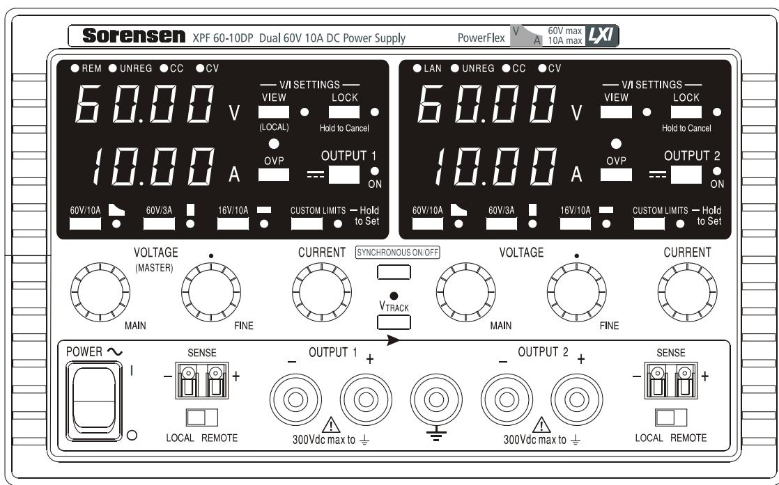
Die Last sollte an die mit OUTPUT (Ausgang) gekennzeichneten positiven (roten) und negativen (schwarzen) Klemmen angelegt werden. Die Ausgangsklemmen (OUTPUT) sind für einen maximalen Strom von 30 A ausgelegt.
