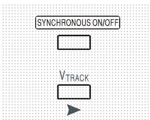
Une pression sur le bouton  $V_{\text{TRACK}}$  permet de sélectionner le mode d'appariement de tension. Les deux sorties restent isolées du point de vue électrique mais les commandes de tension de la sortie 1 (maître) règlent une tension identique sur la sortie 2 (esclave). Les commandes d'intensité du maître et de l'esclave restent indépendants.
