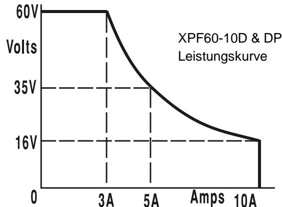
Die Leistungskurve stellt 60V/3A, 35V/5A und 16V/ 10A unter allen Umständen bereit (beide Ausgänge unter Last). Bei niedrigeren Ausgangsspannungen ist die Ausgangsleistung auf maximal 10 A begrenzt.
