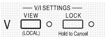
Con la salida encendida, el mensaje **O<sub>P</sub> on** (salida encendida) parpadeará dos veces en la pantalla, mostrándose después la nueva configuración desbloqueada parpadeando durante 2-3 segundos (primero lentamente, luego más rápido) antes de realizar finalmente el cambio; el piloto LOCK se apagará una vez realizado.
