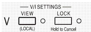
Con la salida apagada, la tensión y límite de corriente configurados se muestran siempre, pero ambos pueden verse también con la salida encendida pulsando la tecla VIEW; al pulsar la tecla se iluminará su piloto correspondiente.
