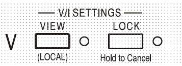
Se l'uscita è ancora inserita, lampeggia due volte sul display il messaggio **OP on**, seguito dal lampeggio per 2 - 3 secondi dei nuovi valori 'non bloccati' (prima lentamente, poi più velocemente) prima della modifica definitiva; la spia LOCK si spegne a modifica apportata.
