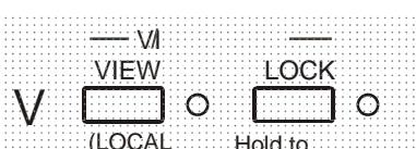
Si la sortie est encore activée, **OP on** (sortie activée) clignote deux fois sur l'écran, puis les nouveaux réglages "déverrouillés" clignotent pendant 2 ou 3 secondes (doucement, puis plus rapidement) avant de mettre en œuvre la modification ; le voyant **LOCK** s'éteint lorsque la modification est effectuée.
