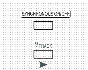
La pulsación de V<sub>TRACK</sub> habilita el modo de seguimiento de tensión. Las dos salidas permanecen aisladas eléctricamente pero los controles de tensión de la salida 1 (la maestra) establecen una tensión idéntica en la salida 2 (la esclava). Los controles de corriente de ambas continúan independientes.
