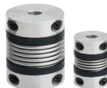
金属波纹管联轴器可提供最佳的同心度校正。为了获得最佳的同心度校正，我们建议使用扭转刚性金属波纹管联轴器。这些联轴器在扭矩不足和极低的恢复力下具有极高的扭转刚度。夹紧紧固件分为两部分，便于安装和拆卸。
