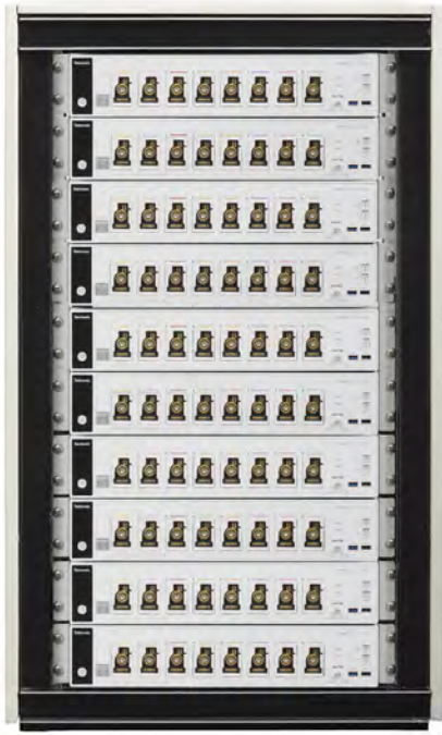
多台 MSO58LP 仪器安装在一个机架中，有效利用可用的空间。
