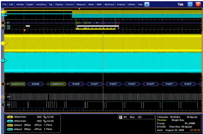
以 25 GS/s 捕获 10ms 时长内同时发生的高速和低速信号。
