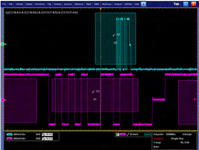
多条通道触发。可视触发区域可以与跨越多条通道的事件相关，如两条 USB 2.0 总线上同时传送的数据包。
