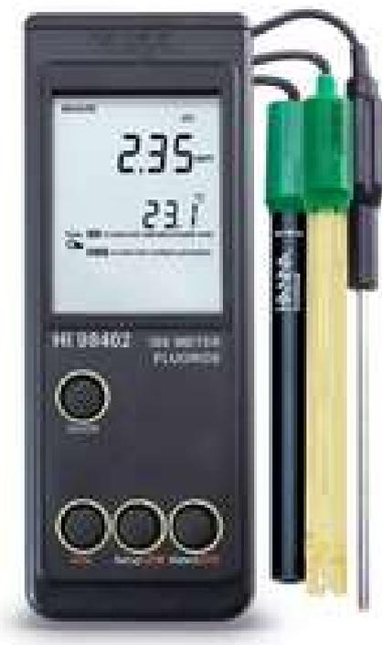
**HI98402** 防水型高精度氟化物测定仪，测量范围在 0.050mg/L 至 1.90g/L 之间，设计小巧，易于手持操作，超大 LCD 屏幕显示数据更为清晰，可根据情况自动设定测定范围和最佳的解析度，测定结果可直接显示。为保证最大重复性，测量采用 HI4010 氟离子选择半电池电极和独立的 HI5313 参比电极。
