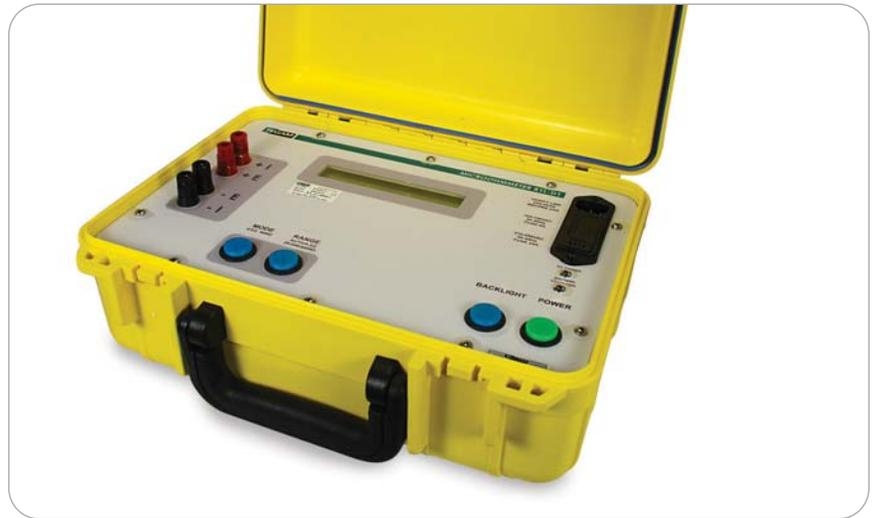
R1L-D1型数字高分辨率微欧计是用来测量低阻值的便携式微欧计和RTD监视器。该仪器适用于低测试电流下的低阻测试，例如100和1000Ω的三线和四线铂电阻(RTD)测试，并利用四线技术减少引线电阻带来的误差,即两个引线产生恒流源通过被测电阻，另两个独立的引线测试电阻两端的压降。R1L-D1型仪器在测试中计算出被测电阻的阻值并在LCD上显示出来，同时也支持两线和三线测量。
