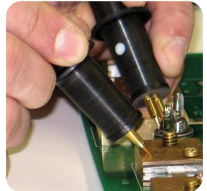
上图所示为使用BCP-10 探针测试分流器和电路板之间路径的接触电阻
