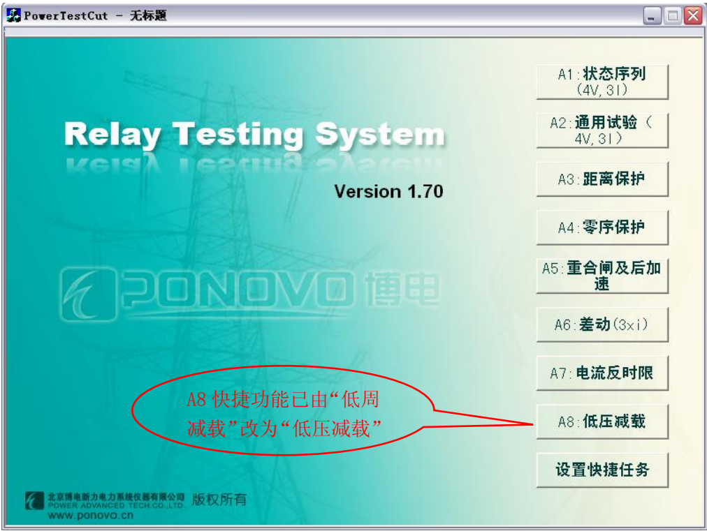
图 3-5 A8 按钮测试模块修改后的主界面
