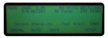
型号 280A 平板测试仪的 LCD 显示屏容易阅读和追查操作参数,用户只需简单按下一个制,就可调节测试参数。
