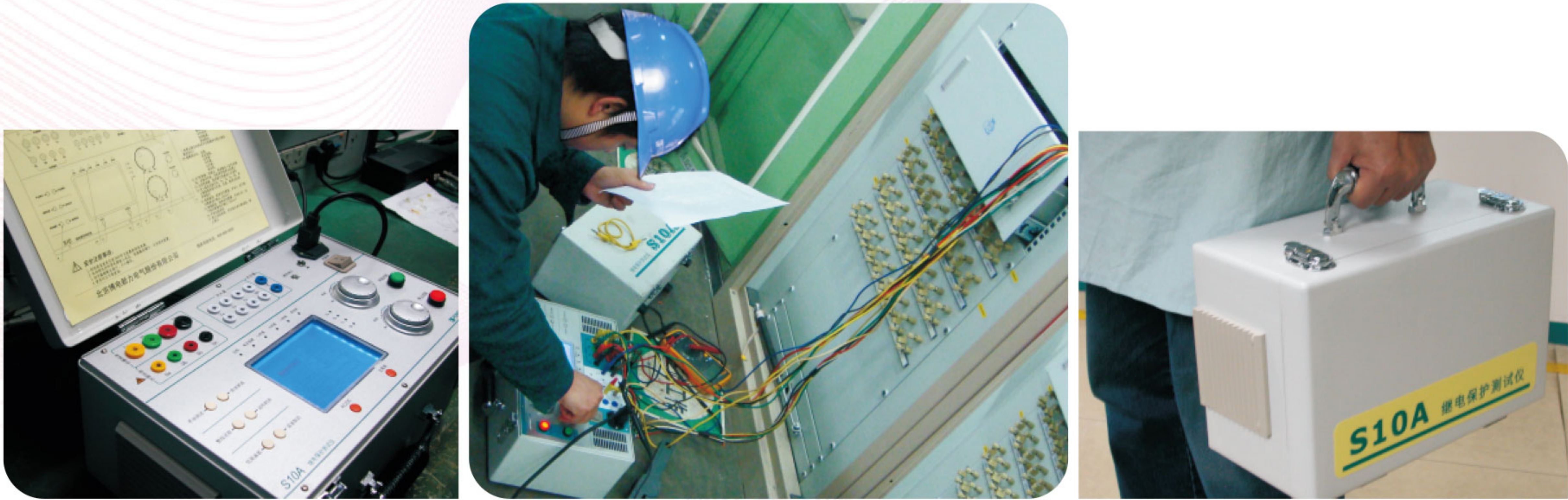
S10A继电保护测试仪现场测试
