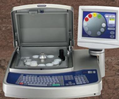
X-Supreme8000 将针对应用优化的硬件和简单而强大的软件结合起来，帮助轻松获得可靠、可重复的结果。为执行测量，操作员只需准备样品，将其载入自动装样器，然后按下开始按键。结果显示在屏幕上，包括合格/不合格消息以及如何处理不符合规格样品的说明。为实现额外的灵活性，X-Supreme8000 允许高级用户通过指南，轻松开发自定义的校准。
