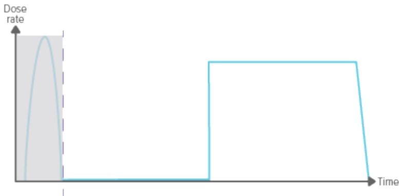
忽略前置脉冲 = 1，（第一个）前置脉冲得以从测量中排除。
