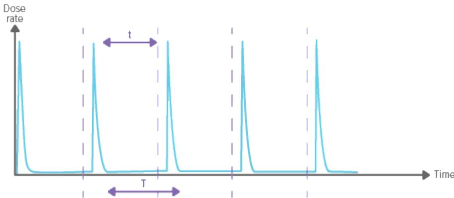
关闭延迟设置比脉冲间隔时间更短 ( $t < T$ )，将导致许多次短时间的测量（一个脉冲一次）。
