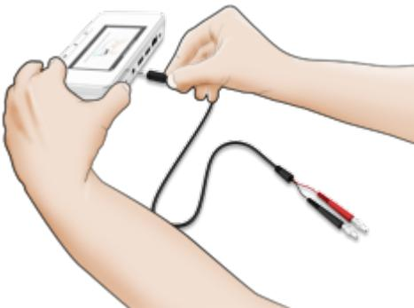
连接 mAs 电缆至主机和发生器上。
