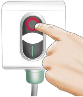
关闭 X 射线发生器。
