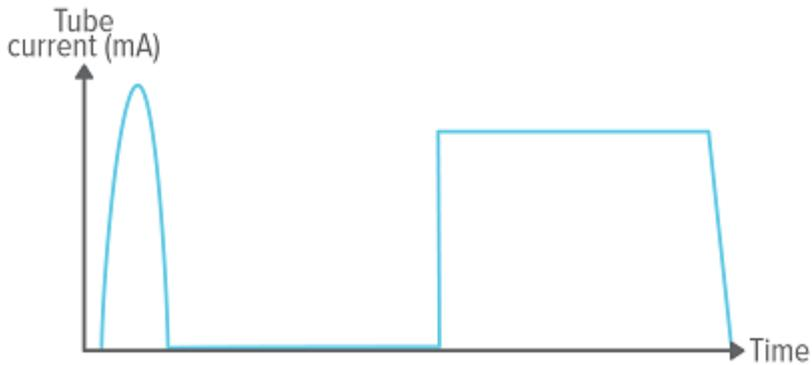
忽略前置脉冲 = 0，整个曝光时间得以采集。
