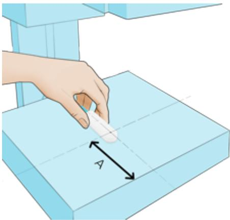
MAM Sensor 随时可以为所有未更改任何设置的阳极/滤过组合测量剂量和半价层。将连接的传感器置于距检查床外边缘 (A) 6 cm (在美国为 4 cm) 处有十字光标的场中央。水平面中的视角对测试结果的影响可以忽略。
