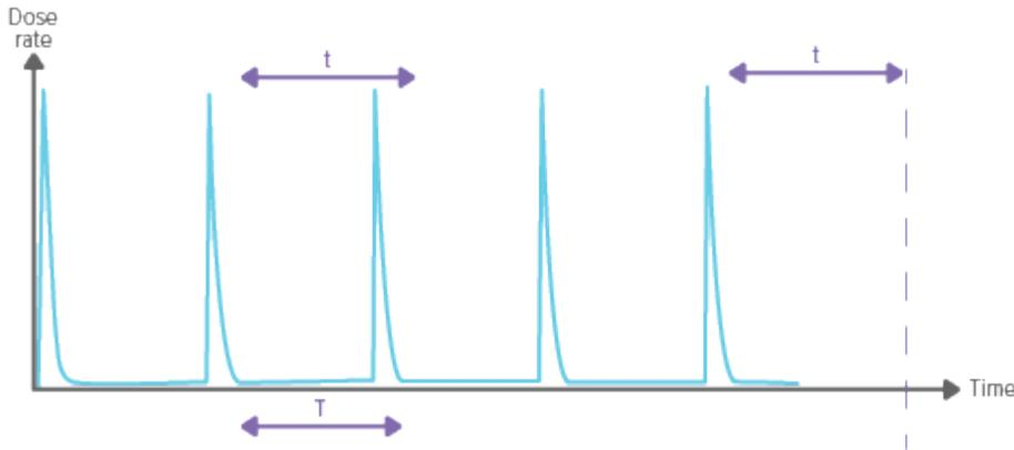
关闭延迟设置时间比脉冲间隔时间更长 ( $t > T$ )，将产生一次较长时间的测量。请注意，您的等待时间必须与测量结束前的最后曝光以后的关闭延迟设置时间 ( $t$ ) 一样长，才能显示值。
