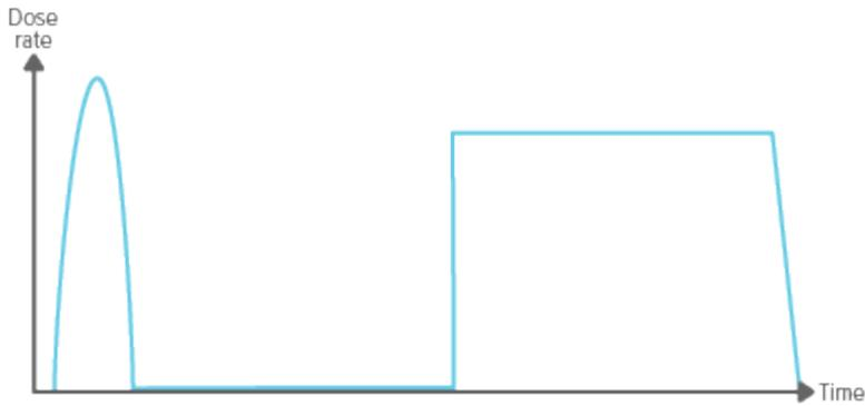
忽略前置脉冲 = 0，整个曝光时间得以采集。
