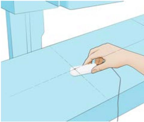
将连接的传感器置于带有面向 X 射线源的十字光标的场中央。水平面中的传感器视角对测试结果没有影响。
