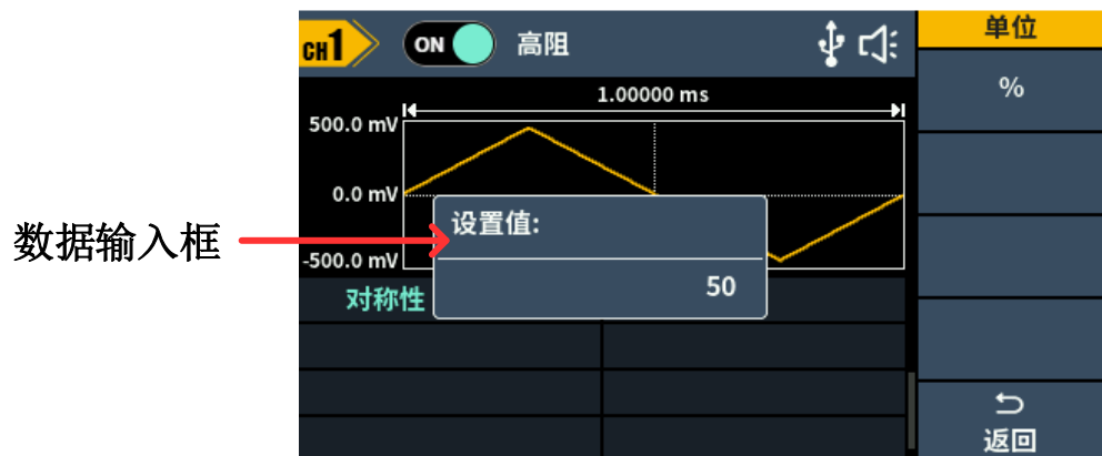
图 5-6：设置锯齿波的对称性
