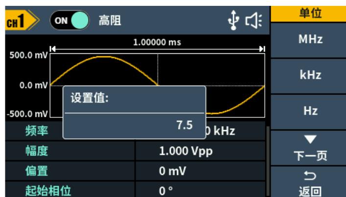
图 5-3：使用数字键盘设置频率
