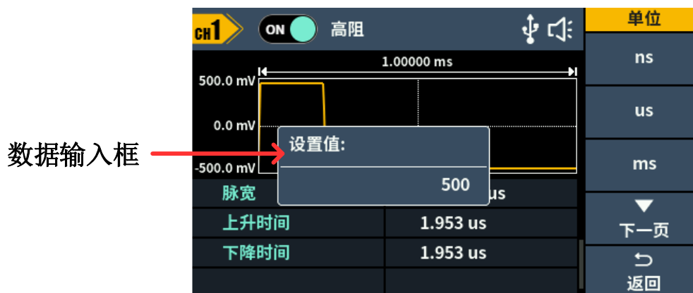
图 5-8：设置脉冲波的脉宽
