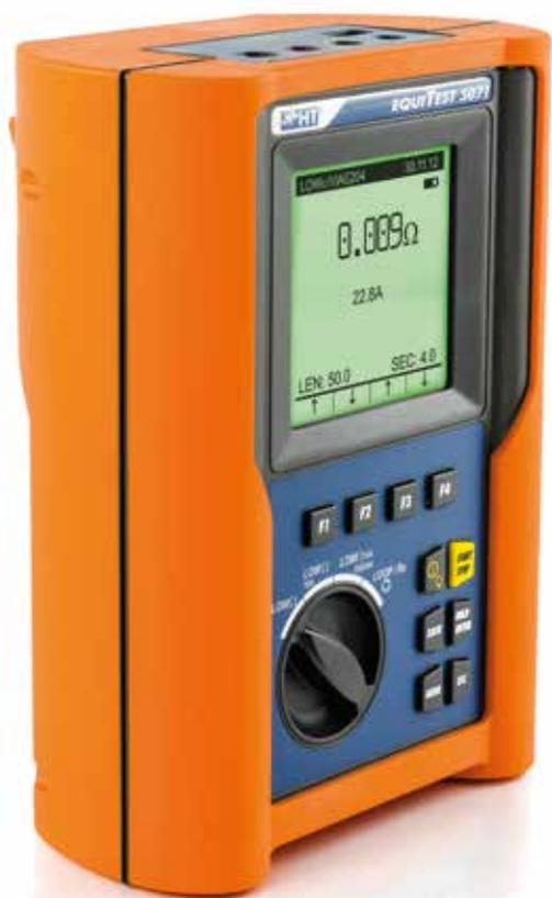
根据医疗环境测试标准与IEC/EN60204-1：2006（电力机器与机器电路板）的规定，EQUITEST5071主要用来测试电流大于10A 的等电势体导体。使用可选配件IMP57，该设备可执行保护性导体的通断测试（电流200mA、高精度测量线路 / 回路的阻抗（分辨率0.1mΩ）、非跳闸接地电阻（不会引起RCDs跳闸与相序的改变）。测量结果保存在内存中，通过提供的Windows软件数据传输到个人电脑。
