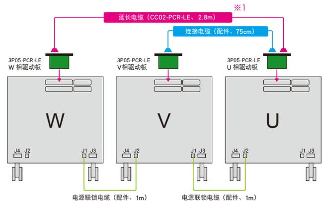
※ 上面的系统构成时，机器启动时的电源连动相与操作时的主机可能不是同一台。
