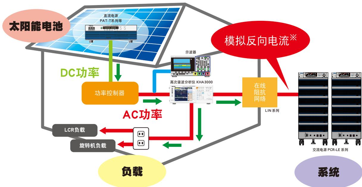
※模拟的反向电流全部在内部消耗掉，没有流向系统的电流。
