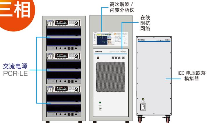
本系统可以模仿交流电源环境中的各类现象。在以下的规格条件下，可使用在与低压配电系统接续的电气，电子仪器，以及带有 DC 电源输入板的电气，电子仪器的抗扰性试验中。可在规格范围之外设定试验条件，因此可用于规格试验前的预审确认试验，抗扰性的余量容限试验以及应力试验。并且高次谐波 / 闪变分析仪 KHA3000 中，能够将交流电源 PCR-LE 系列及在线阻抗网络 LIN 系列和应用软件组合起来，进行适合 IEC 规格及 JIS 规格的试验。
