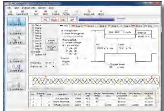
SD009-PCR-LE/WE (品名:Quick Immunity Sequencer 2) 使用的是交流电源 PCR-LE 系列。此应用软件在 EMC 规格的抗扰度试验规格 (IEC61000-4 系列) 中，以电源线抗干扰规格为基础执行了抗干扰试验。本软件在可用于新标准要求的试验及一部分预备试验之外，也能够通过扩大试验条件来进行设定。因此也可用于开发阶段的预审确认试验及抗干扰性余量容限试验。
