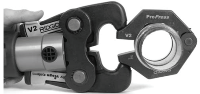
图9 将转换压接环连接到压接环上
