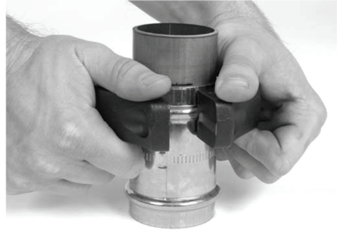
图8 将转换压接环安装到管件上
