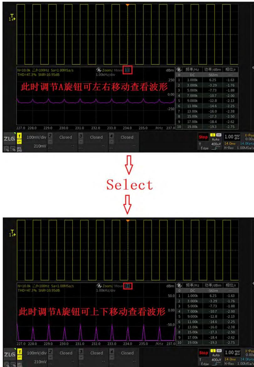
图 18-7 垂直幅值调节和水平频率调节切换
