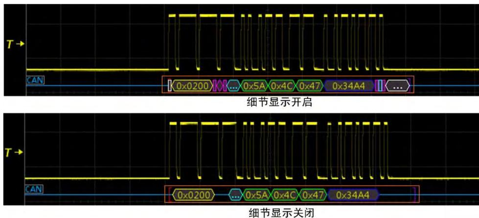
图 15-16 细节显示与细节显示关闭
