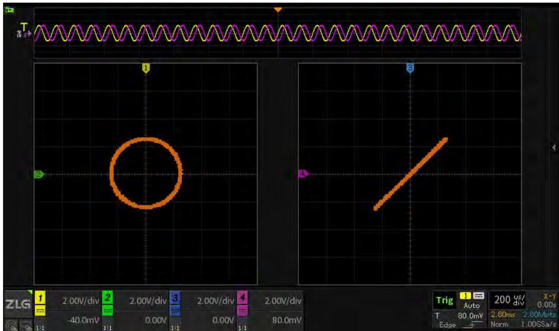
图 9-9 4 通道示波器 X-Y 模式
