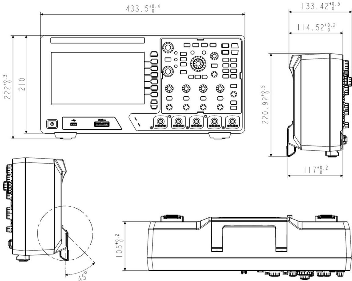
图 24-1 ZDS2000C 示波器尺寸图
