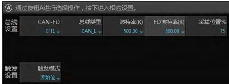
图 15-20 CAN-FD 协议参数配置
