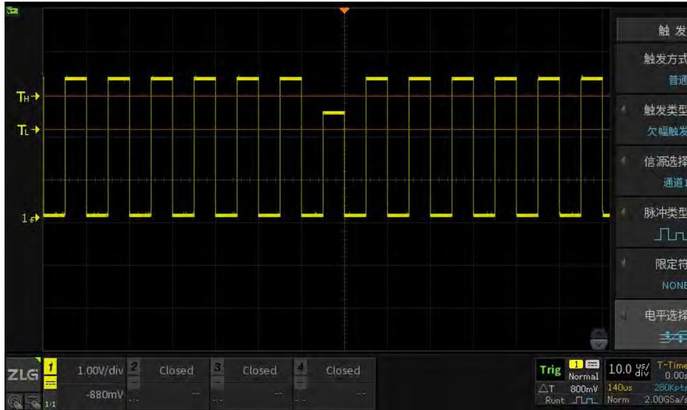
图 10-10 欠幅触发
