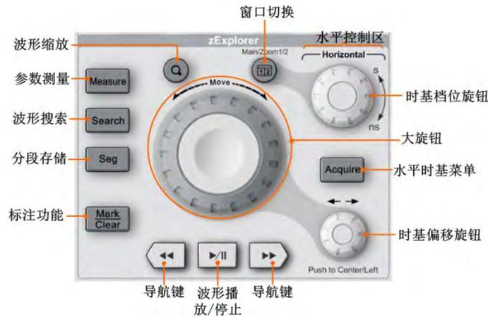
图 5-12 波形探测区
