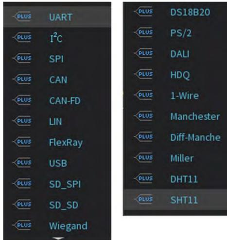
图 15-2 协议解码类型
