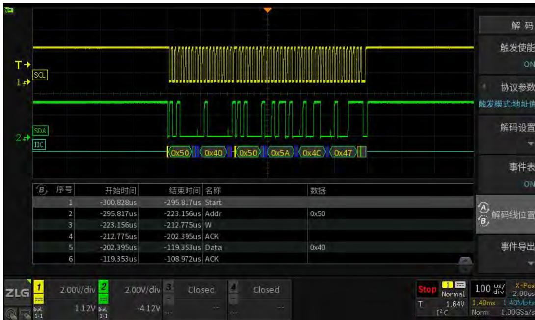
图 15-25 I<sup>2</sup>C 协议解码图（7 位地址模式）
