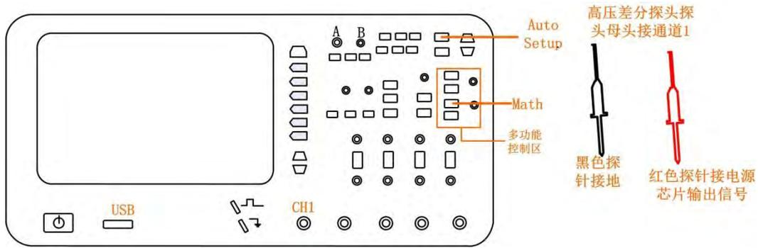
图 17-13 接入电源芯片输出信号
