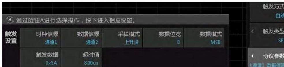
图 10-54 SPI 触发协议参数
