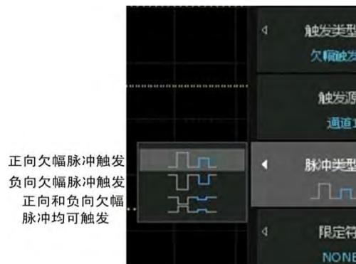
图 10-31 欠幅触发的脉冲类型
