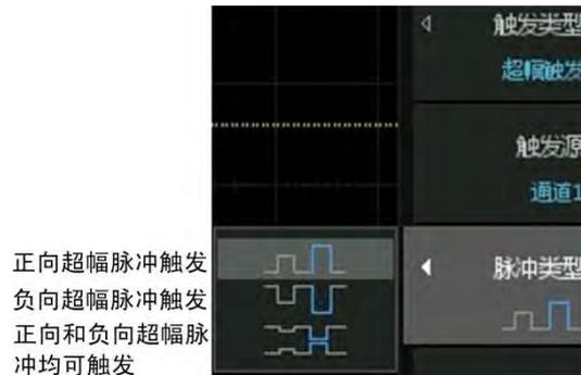
图 10-35 超幅触发的脉冲类型
