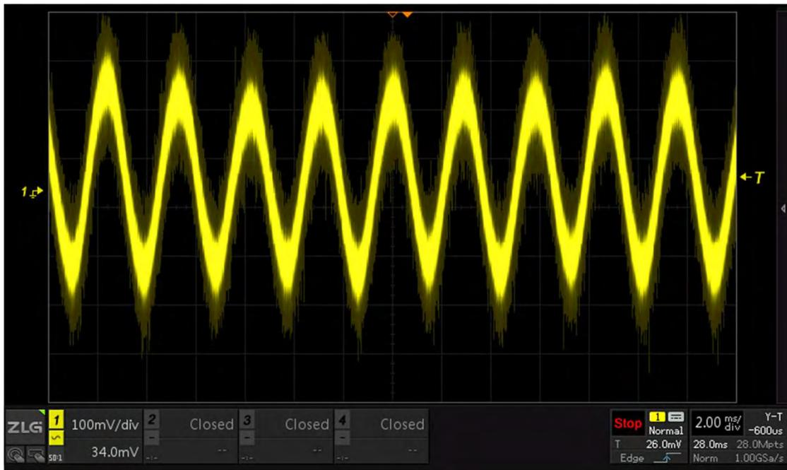
图 17-14 电源芯片输出波形
