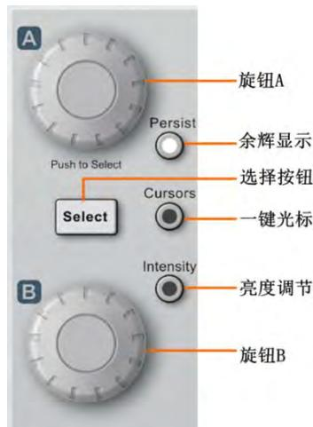
图 5-11 多功能旋钮区面板
