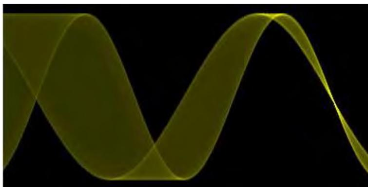
图 9-18 灰度显示模式下的波形全局图
