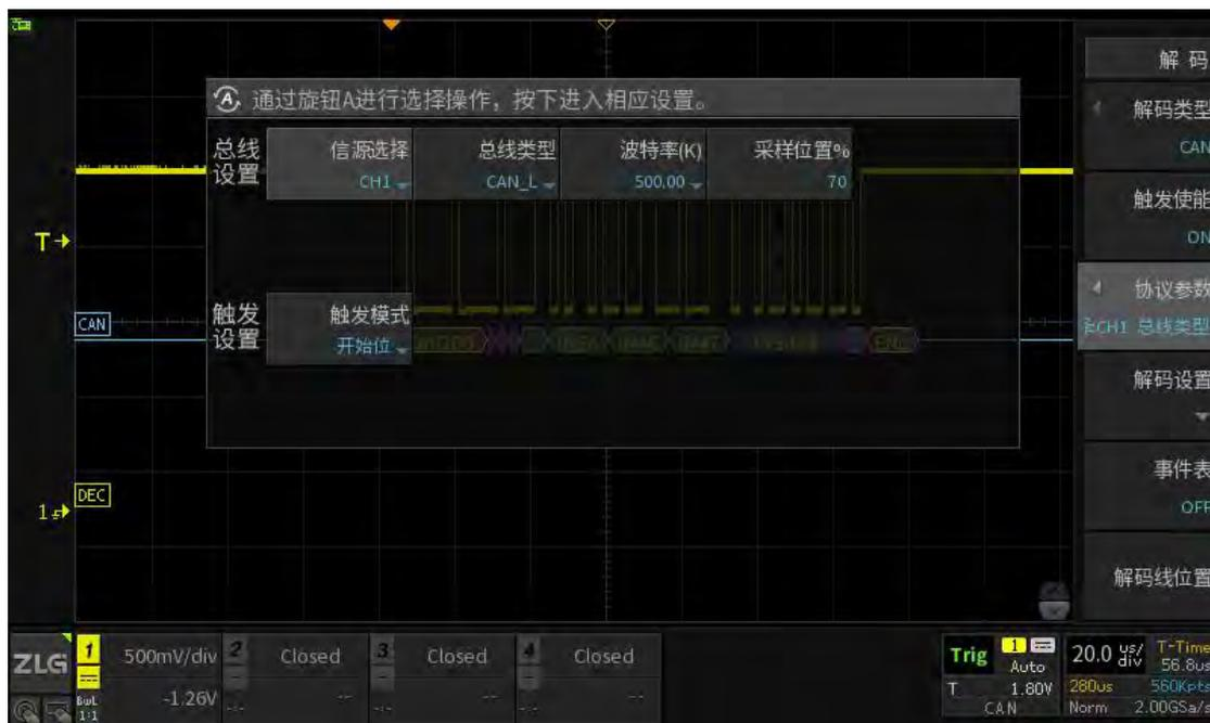
图 15-7 CAN 协议解码参数设置
