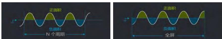
正面积：测量波形和接地电平之间上方的面积；
