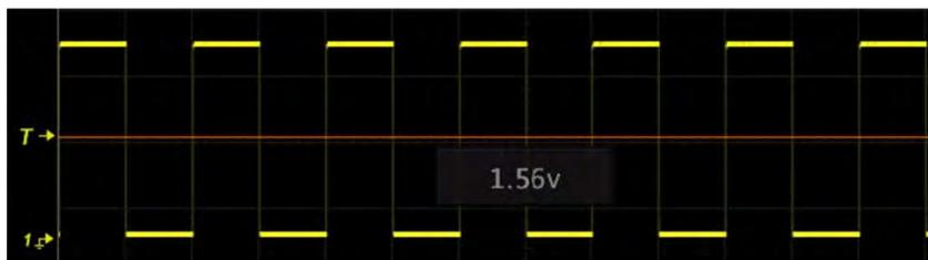
图 10-2 触发电平线
