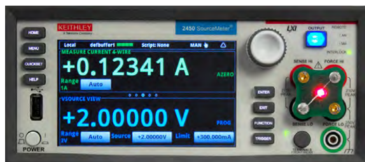
图1 利用2450型触摸屏数字源表测量红色LED的I-V特性
