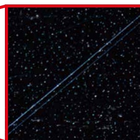
微分干涉①：可立体地观察在一般的明视场观察中较难观察到的微小凹凸。
