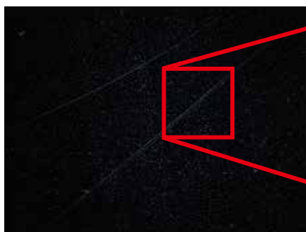
暗视场①：使用散射光，可观察到细微处的划痕和痕迹。
