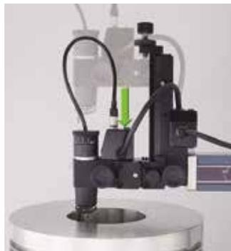
可在足够高的位置处停止Z轴，然后向下滑动检出器支架进行定位并测量。还可使用内外径连续测量<sup>※2</sup>方式轻松测量内外径。
