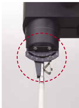
检出器部分配备安全装置。检出器(纵向姿势时)备有可检测Z轴方向碰撞的碰撞检测功能。另外，还备有在检出器位移超出范围时停止运行的防意外触碰功能。一旦感应到意外触碰，专用分析软件(ROUNDPAK)会提示错误，自动停止设备。
