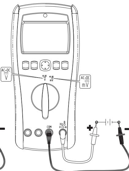
为在量测 DCmV 时取得最高准确度，将探针尖端相触以读取 DC 偏移。如有必要，可采用相对 ( $\Delta$ ) 模式自动减去偏移值。
