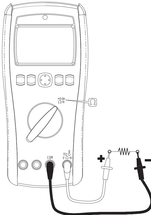
量测电阻的量程为  $400\Omega$ 、 $4k\Omega$ 、 $40k\Omega$ 、 $400k\Omega$ 、 $4M\Omega$ 、 $40M\Omega$ 、 $400M\Omega$  和  $4G\Omega$ 。
