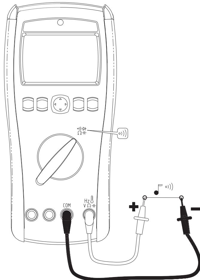
导通性检查的特点为蜂鸣器，每检查完一个电路就会响起。蜂鸣器让您无需紧盯萤幕，即可快速进行导通性检查。
