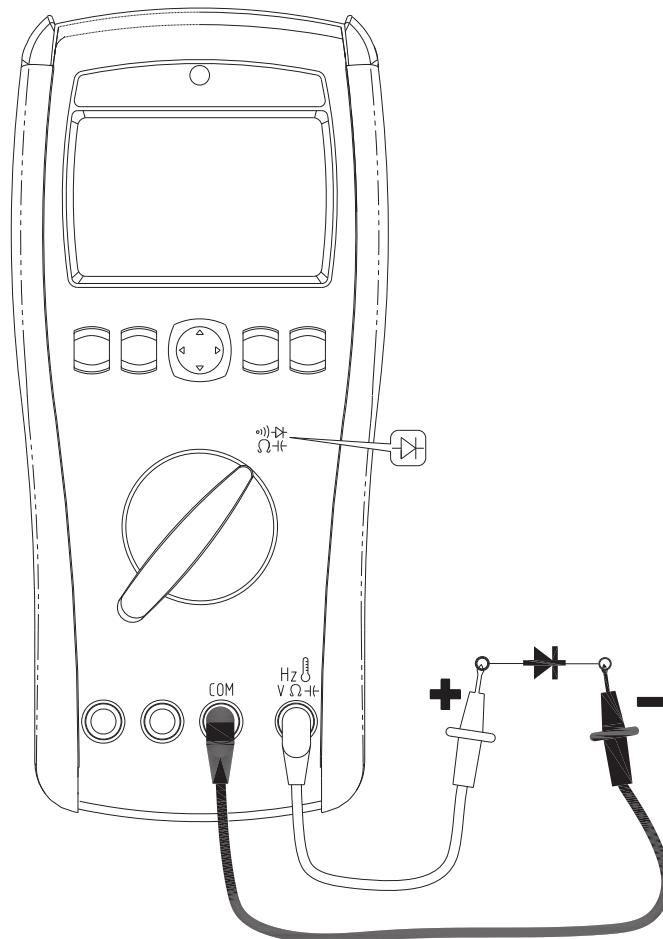
进行二极体测试来检查二极体、电晶体、矽控整流器 (SCR) 和其他半导体装置。此功能透过传送电流穿过接面，接着量测接面的压降来测试半导体接面。良好的矽接面可达到介于 0.5V 和 0.8 V 间的压降。
