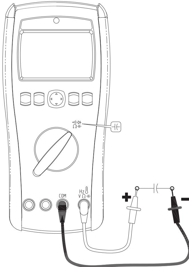
量测电容的量程为 40nF、400nF、4uF、40uF、400uF、4mF 和 40mF。
