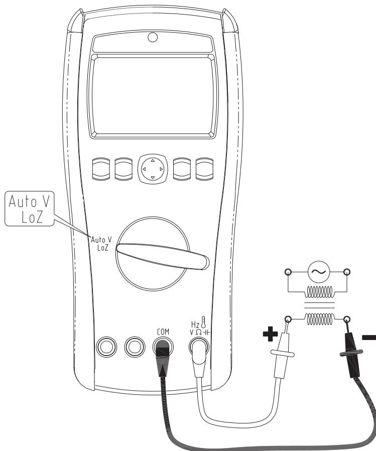
为消除假性电压，在仪表的 LoZ 模式下，测试棒的阻抗会变低，以取得更准确的量测值。量测 LoZ 电压的量程为 400V 和 1000V。在 LoZ 模式下，仪表会自动量测 AC 或 DC 输入讯号，并决定量程。
