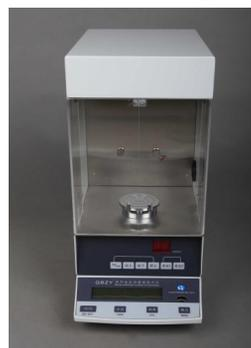
★. 使用铂金板时，能实时测量液体的表面张力，对于测量含有表面活性剂或挥发性物质，其表面张力会随时间不同而发生变化的试样，非常实用（选用数据处理软件，可实时记录测试曲线，清晰得到变化的详细情况）；
