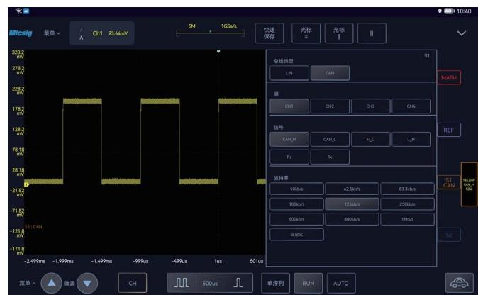
支持汽车诊断常见的 LIN 和 CAN 串行总线解码和触发，同时显示波形和数据；可帮助使用者准确直观地解决信号完整性问题，快速做出故障诊断。
