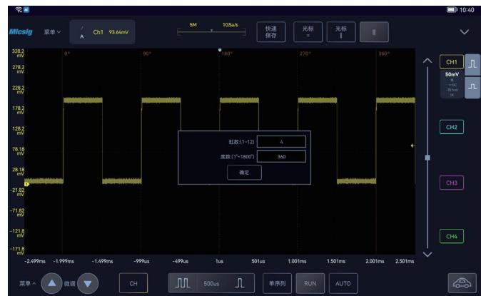
支持相位标尺，根据设置的缸数和角度，可帮助测量循环波形的定时时间。如测量四缸曲轴信号，一般设置角度为 720°，一个循环包含两次曲轴旋转。
