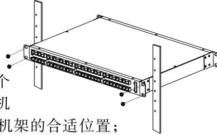
第二步：将交换机放置在机柜的一个托盘上，根据实际情况，移动交换机至合适位置，注意保证交换机与1U机架的合适位置；
