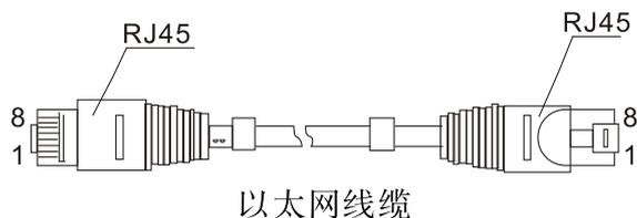
RJ45端口支持自动MDI/MDI-X操作，可以使用直通线连接PC或服务器，连接其它交换机或集线器。在直通线（MDI）中，管脚1、2、3、6对应连接；对于交换机或集线器的MDI-X端口，采用的是交叉线：1→3、2→6、3→1、6→2、4→7、5→8、7→4、8→5。MDI/MDI-X应用中的10/100/1000Base-T引脚定义如下表所示。
