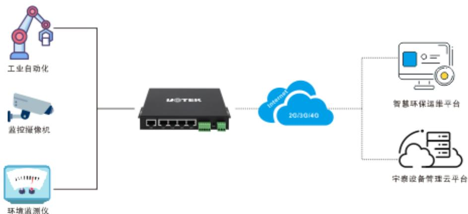
R9607系列工业路由器产品，支持移动蜂窝，Wi-Fi，有线网络等接入方式。通过设备管理云平台进行远程配置和管理，可视化、远程运维管理系统解决方案，广泛应用于智慧电力、智慧农业、智能交通、智慧医疗、智慧工厂、智慧水利、智慧环保、智慧城市、工业控制等领域。
