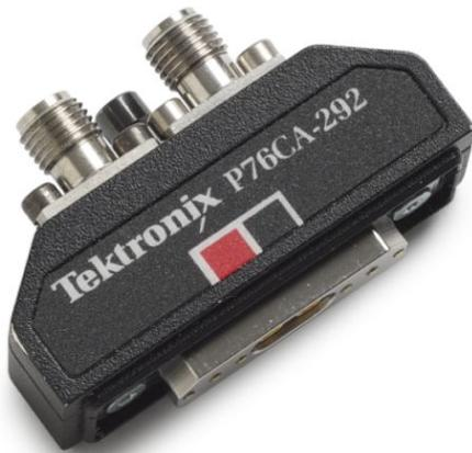
33 GHz 带宽同轴适配器，带 2.92 mm (孔型) 连接器。此适配器在输入连接器上校准，非常适用于与现成的或定制的电缆配合使用。应使用低时滞电电缆对以保持全带宽性能。
