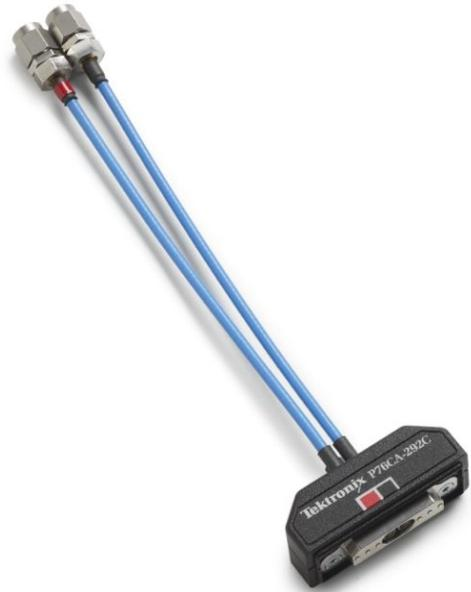
33 GHz 带宽同轴适配器，带 2.92 mm (针型) 连接器和 6" 高性能电缆。此适配器在输入连接器上校准，非常适用于连接带有 2.92 mm 或 SMA 输出连接器的设备。
