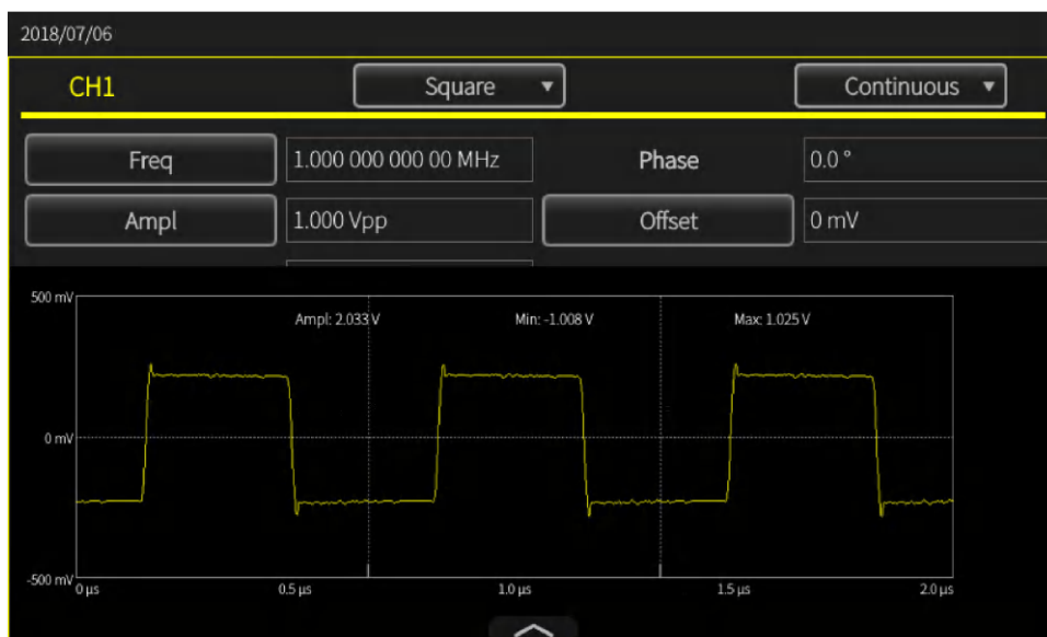
图 71: CH1 示波器 1 MΩ – InstaView
