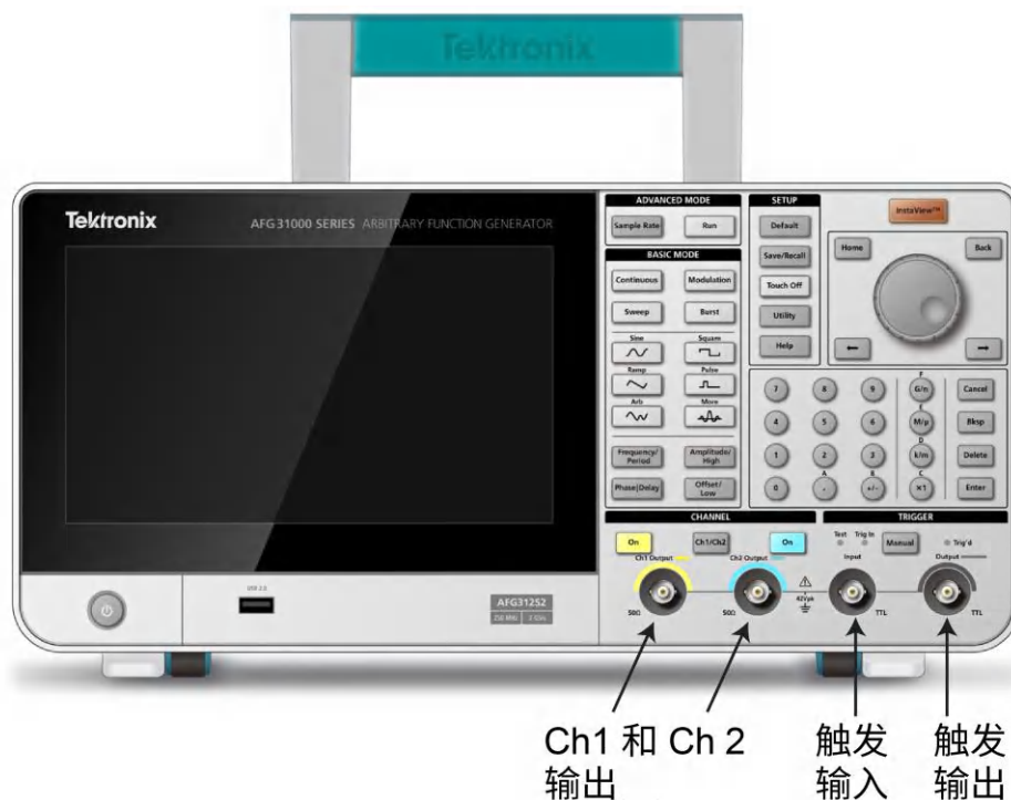
图 2：AFG31000 系列前面板输入和输出
