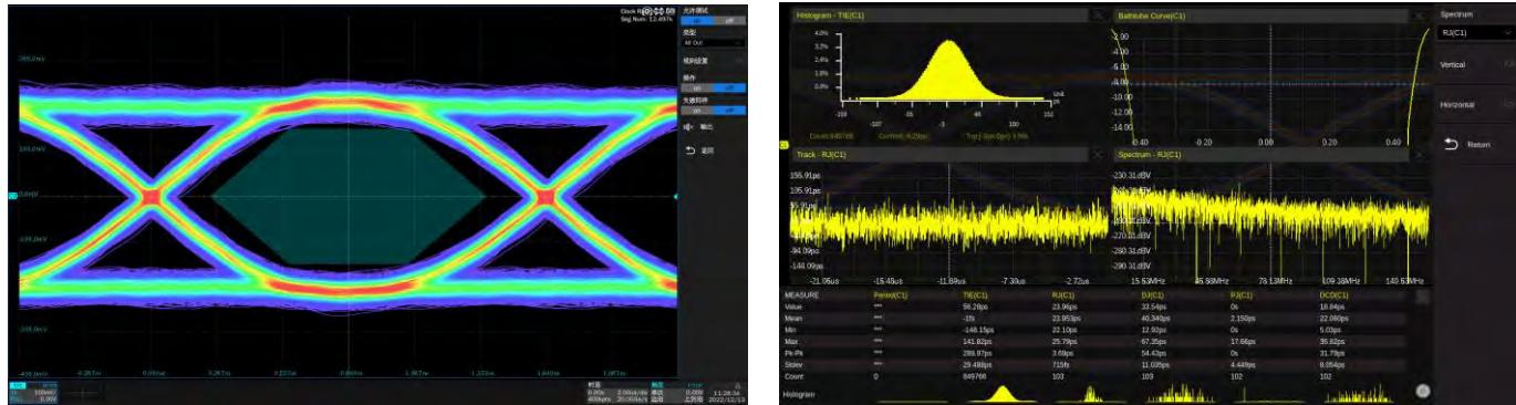
对数字信号进行眼图和抖动分析，自动从串行数据中提取时钟用于重构眼图和进行抖动计算；支持多种眼图和抖动参数的自动测量；支持对眼图的模板测试
