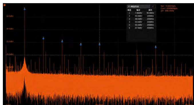
通过硬件加速的 FFT 功能，最大运算点数为 32M 点，在提供优越的频谱分辨率的同时，仍然能够保持较高的频谱刷新率。支持多种窗函数，支持普通、平均、最大值保持等模式，支持自动标记峰值点
