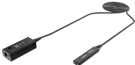
SAP5000D 系列有源差分探头，带宽 5GHz，上升时间 80ps，差分输入电容 350fF，衰减比 10:1，可搭配 SDS7000A 使用
