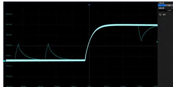
分段采集将波形储存空间分成多段，每段空间存储一个触发帧，最大可以采集 124000 个触发事件，在 Sequence 周期内可最大限度地降低触发事件之间的间隔时间（小至 0.9 μs），提高对异常事件的捕获概率。Sequence 模式下采集的所有波形段可以一次性全部映射到屏幕上，也可以通过 History 进行单帧回放
