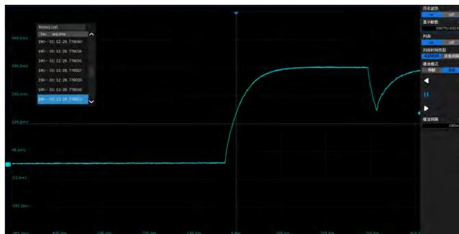
最大可记录 124000 帧波形；自动实时录制，随时可回放历史波形观察异常事件，并通过光标或测量参数快速定位问题来源；可录制模板测试的失败帧
