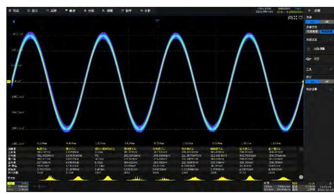
参数统计功能可显示任意参数的五种测量值：当前值、平均值、最小值、最大值、标准差；可同时测量统计 12 种不同的参数。直方图统计可以直观地显示参数的概率分布情况；趋势图和轨迹图可反应参数随时间的变化规律。
