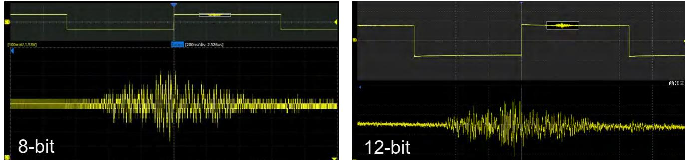
12-bit 高分辨率采样，通过水平方向和垂直方向的 Zoom，更好地呈现波形细节
