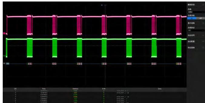
通过事件列表显示解码, 能快速、直观地将总线的协议信息以表格形式显示。支持 I<sup>2</sup>C、SPI、UART、CAN、LIN、CAN FD、FlexRay、I<sup>2</sup>S、MIL-STD-1553B、SENT、Manchester 和 USB2.0 等多种协议
