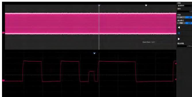
通过指定条件, 对一帧波形进行自动搜索, 并把符合条件的事件标识出来。结合导航功能, 快速地定位到感兴趣的事件, 然后借助示波器的分析功能对事件进行详细的分析, 省去了手动搜索的耗时和不便。导航可以对搜索事件导航, 也可以对时间和历史帧导航
