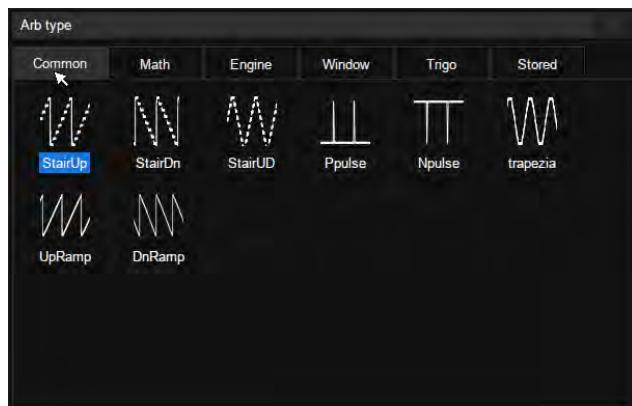
内置 50 MHz 函数/任意波形发生器功能，集成了几十种常用内置波形，也可通过从外部导入波形。用户可直接将示波器捕获的波形通过波形发生器还原
