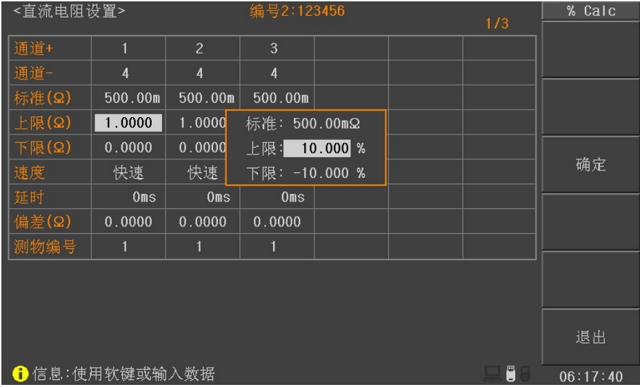
图 4-1-5-4 直流电阻上下限%换算
